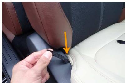
5 外側のシートの付け根部分の生地に、ゴムが付いています。ゴムとゴムが付いている生地の端をシートの隙間に入れ込みます。
