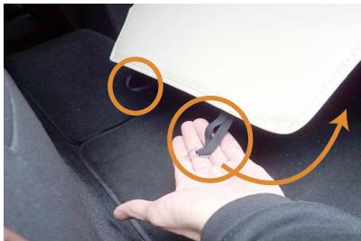
9 カバー背面下部の生地に付いているゴムに付属の金属フックを取り付けます。
