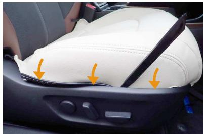
4 外側面のカバーの縁に固定部材が付いています。固定部材を生地と一緒にシートの隙間に入れ込みカバーを固定します。内側面も同様の手順で固定します。
