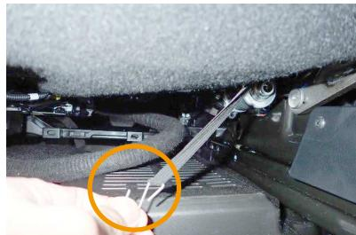
6 シートの裏側からゴムを引き出し、付属の金属フックを使用して、シート底面のフレームなどに引っ掛けて固定します。内側のシート付け根部分の生地に付いているゴムも、同様の手順で固定します。
