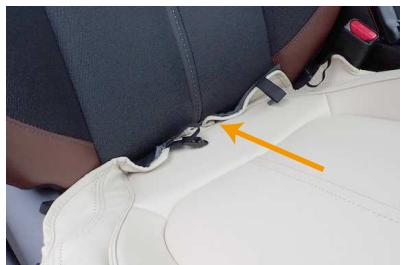
2 背もたれと座面の隙間に生地を入れ込みます。背もたれの角度を調整して、生地が入れ込みやすい位置で作業を行って下さい。
