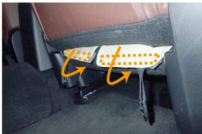
3 入れ込んだ生地をシートの背面側から、座面と背もたれの間にある配線をかわしながら引き出し、引き出した生地に付いているマジックテープをシートに固定します。
