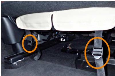
9 引き出したベルトを、3番で引き出した生地に付いているバックルに通して固定します。
