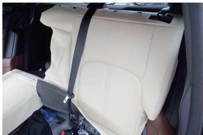
7 カバーを装着していきます。カバーのファスナーを開いた状態にして、中央席用のシートベルトをかわしながら、シート全体にカバーをかぶせます。
