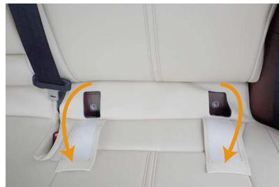
12 I SOF IX対応のチャイルドシートを使用する場合は、カバーの隠し生地を外すことで、カバーに穴を開けていますので、カバーの穴を通してチャイルドシートを固定して下さい。
