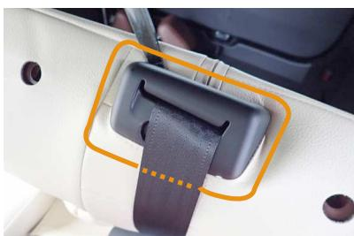
9 ファスナーおよび生地を、シートとシートベルトを固定しているプラスチックパーツとの隙間に、ヘラ等を使用して入れ込みます。
