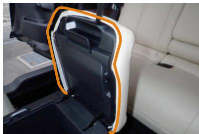
2 前面と側面のフタとフタの裏側のプラスチック部分との隙間に、ヘラ等を使用して生地を入れ込みます。
