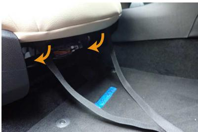
7 カバーの前側に付いている2本のベルトをシートの裏側を通して、シートの背面から引き出します。
