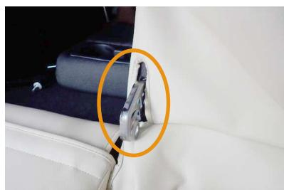
11 アームレストを固定しているパーツを、カバーの加工穴から抜き出します。
