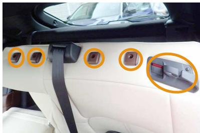
10 ヘッドレストの台座をカバーの加工穴から抜き出し、肩口のプラスチックパーツとシートの隙間に生地を入れ込みます。
