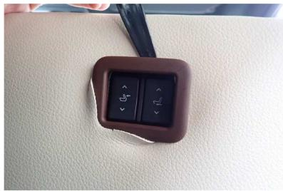
10 背面上部のスイッチ部分のプラスチックパーツとシートの隙間に、生地を入れ込みます。
