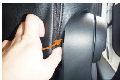
10 側面の生地を図のように、シートの隙間に入れ込みます。
