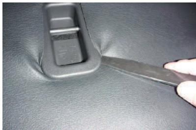
7 シート背面のチャイルドシート固定用具の隙間に生地を入れ込みます。
