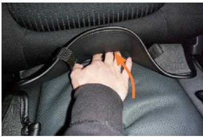
7 背もたれと座面の隙間に生地を入れ込み、後ろ側から引き出します。背もたれの角度を調整して、入れ込みやすい位置で行って下さい。
