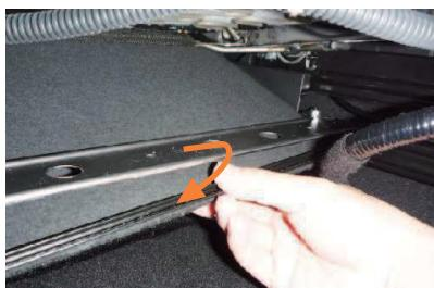
2 シート底面の金属部分にプラフックが巻き付くように固定されていますので、外します。
