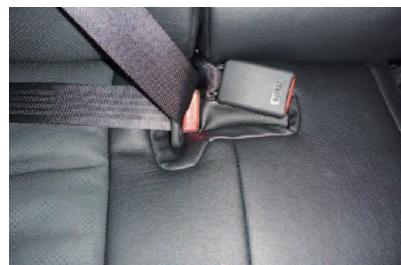
16 シートベルトバックルが取り出せない場合は、バックルをシートの隙間から少し出した状態でシートベルトを装着します。シートベルトを引っ張り、シートの隙間からバックルを引き抜くように取り出します。
