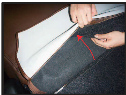
⑨固定を外した生地をカバーの中へ入れ込みます。
