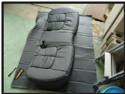
⑧シートのラインがずれないようにカバーをかぶせていきます。
