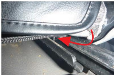
7 6番で引き出したヒモは、図のようシートレールの隙間に引っ掛けるようにします。
