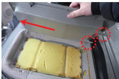
2 ネジを取り外し、トレーを前側にスライドさせると、トレーを固定しているツメ（図の○部）が外れ、トレーが取り外せます。
