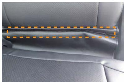
11 座面カバーに付いている生地と、背もたれカバー下部の生地に付いているマジックテープを固定します。
