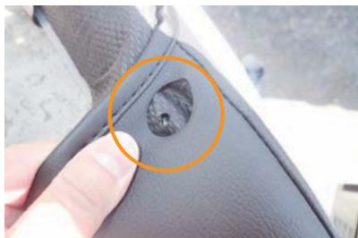
9 1番で外したゴムバーツのネジ穴と、カバーの加工穴の位置を合わせ、ゴムバーツを元に戻します。
