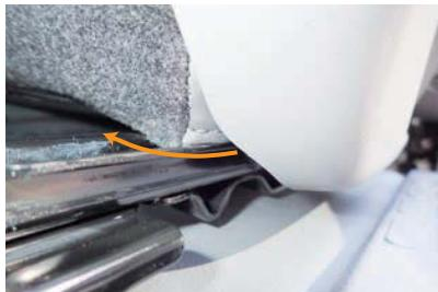
7 引き出したヒモは、図のようにシートとシートレールの隙間に引っ掛けるようにします。
