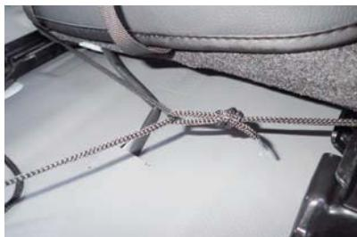
9 シートの後ろ側で、左右のヒモ同士を結び固定します。
