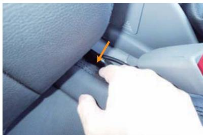
8 内側面の生地をシートの隙間に入れ込みます。生地から出ているヒモは、シートの後ろ側へ通し、7番と同様にシートとシートレールの隙間に引っ掛けるようにします。
