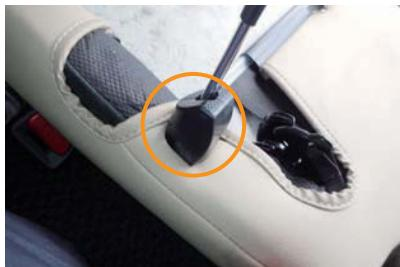
9 1番で外したゴムパーツのネジ穴と、カバーの加工穴の位置を合わせ、ゴムパーツを元に戻します。
