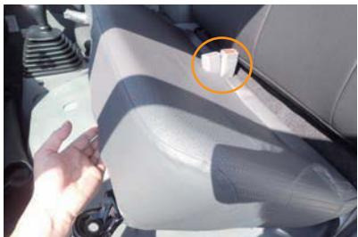
7 4本のボルトを取り外すと、シートが取り外せます。この際、シートベルトのバックル部をシートから抜き取ると、カバー装着後に元に戻すのが困難になりますので、バックル部は抜き取らずに作業する事を推奨します。
