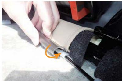
7 引き出した生地に付いているプラフックを純正シート生地を固定しているプラフックの上から引っ掛け、固定します。
