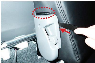
11 ヘラ等を使用し、プラスチック部の隙間に生地を入れ込みます。
