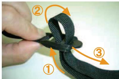
10 ベルトは①～③の順番でバックルに通します。まずバックルの中央にベルトを通して折り返します。次につまみ側の端に通して引くとカバーの前後が絞り込まれ固定されます。ベルトは強く引きすぎると生地が破れたり切れたりするので、注意して下さい
