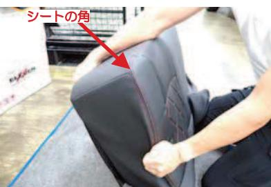
8 カバーをかぶせていきます。シートの角に生地がしっかりと張るようにカバーをかぶせます。
