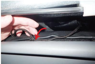
10 ヒモを結び留め、プラスチックトレイの隙間に入れ込みます。
