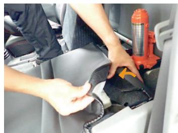
5 シートを倒して、入れ込んだ生地を引き出し、カバーの背面下の生地とマジックテープで固定します。
