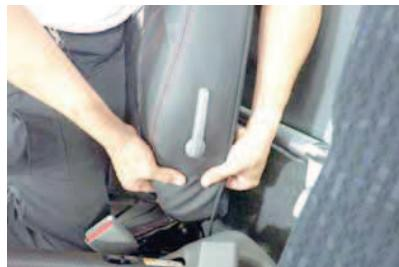
4 ランバーサポート用レバーの軸部分を、生地の伸びを利用して慎重に取り出します。
