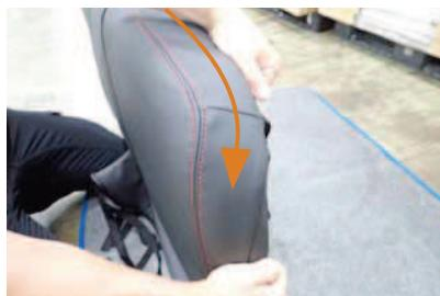
9 片方の角にしっかりとカバーをかぶせたらそこを起点にもう片方の角にもしっかりとカバーをかぶせます。
