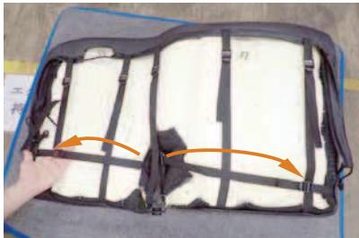
14 10番で入れ込んだ生地に付いているベルトを、カバーの側面のバックルに通して固定します。
