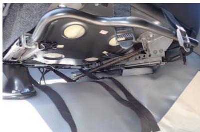
9 シートの前側からベルトを引き出し、カバー前側に付いているバックルに通して固定します。
