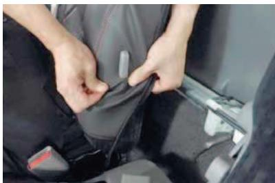
3 シート内側のランバーサポート用レバーにカバーの加工穴を通してます。
