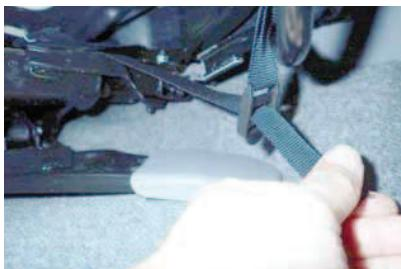
9 引き出したベルトをカバーの前側に付いているバックルに通して固定します。
