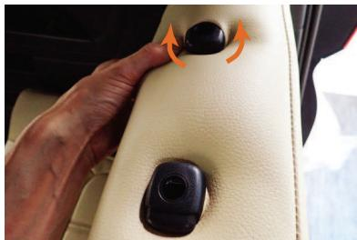
5 カバー肩口のラインをシート形状に合わせます。1、2列目同様にヘッドレストの台座をカバーの加工穴から抜き出します。
