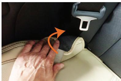
5 側面後端部分はマジックテープが付いた生地を奥まで入れ込み、シート本体に貼り付けて固定します。
