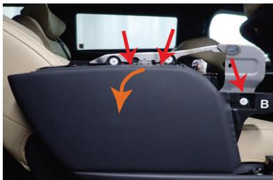
9 アームレスト外側のパネルを外します。図の赤矢印の位置にヘラを差し込み、ひねりながらパネルを手前側に外していくます。
