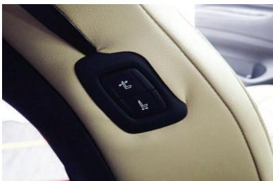
15 助手席側も運転席同様に取り付けますが、内側の側面にパワーシートのスイッチが付いています。カバーの加工穴の位置を合わせて、付属のヘラでスイッチパネルの隙間に生地を入れ込みます。
