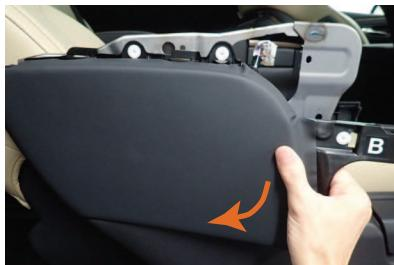
10 パネルは7か所の留め具で固定されています。9番の3か所が外れたら、パネルの前後を手で持ち、手前側に引いて残りの留め具を外します。
