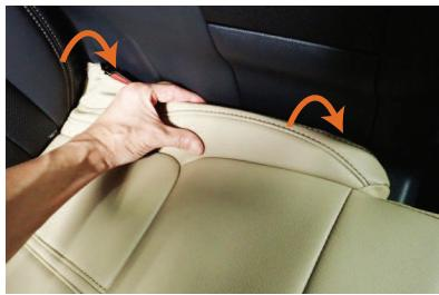
6 内側の側面も同様に生地をプラスチックカバーの隙間に入れ込みます。側面後端部分はマジックテープが付いた生地を奥まで押し込み、シート本体に貼り付けて固定します。
