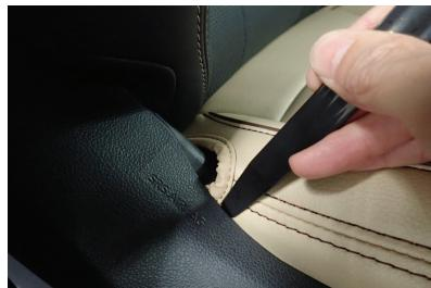
10 外側面後ろ側はプラスチックカバーの隙間が狭いので、少しずつ慎重に入れ込んで下さい。
