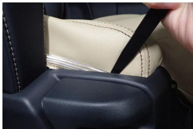
4 外側の側面の生地を、付属のヘラを使用してプラスチックカバーの中に入れ込みます。
