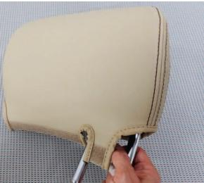
19 3列目中央のヘッドレストカバーをかぶせます。マジックテープのメスが付いている方を前側にしてかぶせます。
