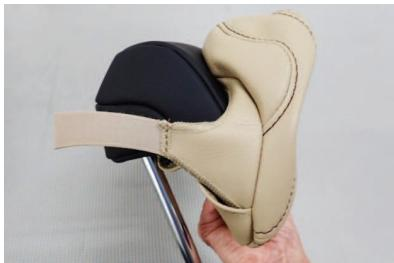
13 3列目のヘッドレストカバーをかぶせます。板状のプラスチックが付いている方が前側になります。ヘッドレストの前側にカバーを引っ掛けるようにします。
