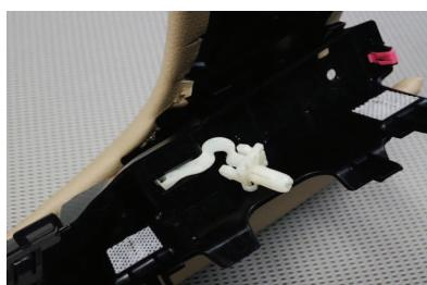
30 26ページ24番で外した部品を取り付け直します。この時、中央の留め具は引き出した状態にしておきます。ゴムを押さえるように裏側の部品をはめ込み、ネジを締めます。
