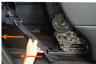
3 外側のツメも同様に外していきます。ツメが全て外れたら車体後方側にプラスチックカバーを引き出して取り外します。
