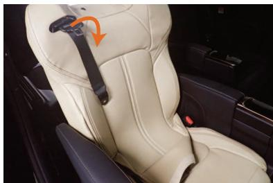
6 背もたれカバーをかぶせます。カバー背面のファスナーを開いた状態で、カバーの加工穴にシートベルトと5番で外した部品を通してからシート全体にカバーをかぶせます。
