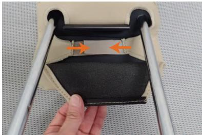
15 カバーの底面に付いているマジックテープを貼り合わせて固定します。
