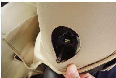
4 アームレストのシャフトが飛び出した部分はカバーを引っ張り、シャフトを通して加工穴の位置に合わせます。
