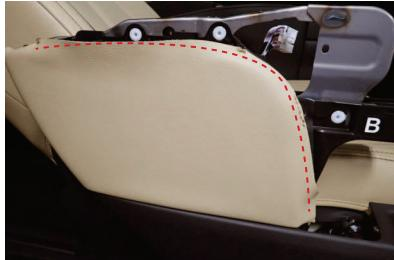
12 破線で示した部分の生地裏に両面テープを貼り、固定しておくと仕上がりが綺麗になります。アームレスト外側のパネルを取り付け直します。
