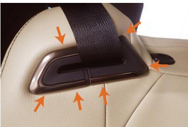
14 生地を挟みながらシートベルト出口の部品をはめ込みます。ツメの位置(矢印で示す位置)を合わせて上から押さえ込むように固定します。取り付け後、シートベルトがスムーズに巻き取り動作するかを確認します。
