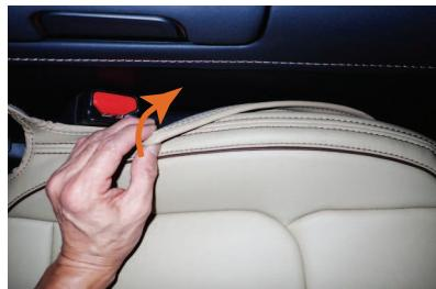
11 内側面の生地はシート本体に直接マジックテープで貼り付け固定します。
