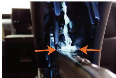
22 中央の留め具は図のように、紐が付いたような状態になっています。隙間からマイナスドライバー等を使用して、矢印で示す突起を押し込み、留め具を外します。
