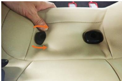
7 ヘッドレストの台座を生地の伸びを利用して、カバーの加工穴から抜き出します。
