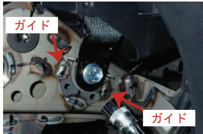
16 ソケットレンチでボルトを締め直します。シートフレームに溶接されているガイドの間に金具を合わせて取り付けて下さい。シートベルトが確実に固定されているか、金具やベルト部分を引っ張って確認して下さい。
