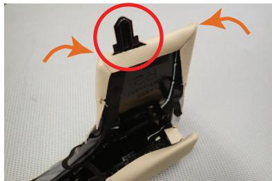
26 図の○部分にカバーの加工穴を通します。矢印の部分はカバーが袋状に縫われているので、アームレストの角に引っ掛けるようにします。
