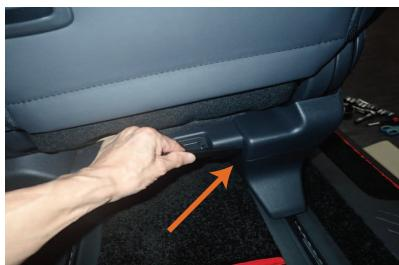
2 背面からプラスチックカバーのツメを外します。図の位置に付属のヘラを差し込み、ひねりながらツメを外していきます。
