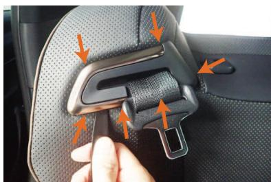
5 背もたれのシートベルト出口に付いている部品を外します。付属のヘラを隙間に入れてツメを外します。
