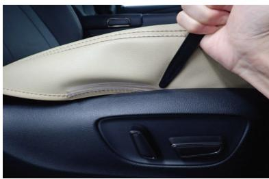
9 外側面の生地を付属のヘラを使用してプラスチックカバーの中に入れ込みます。
