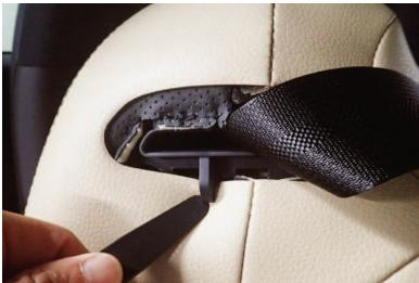
13 シートベルト出口の部品を取り付け直します。図のように、突起部分の下に生地を入れ込みます。
