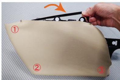
11 パネルにカバーをかぶせます。カバーの袋状に縫われている3か所を①～③の順番にパネルの角へ引っ掛けます。最後に上側のゴムをパネル上部に引っ掛けて、表面にシワができるないように位置を調整します。
