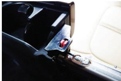
23 アームレスト全体を持ち上げて外すと、フレームの前側にピンク色の留め具が残っている場合がありますので、引き抜いてアームレスト側に留め直しておいて下さい。
