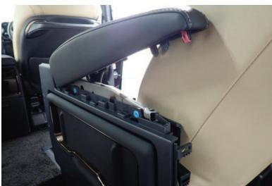
21 後ろ側の留め具が外れたら、続けて中央の留め具を外します。
