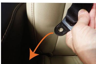
15 シートベルトを取り付け直します。シートベルトがねじれないよう金具に文字が刻印されている側を車体外側へ向けて座面横の隙間から下側に引き出します。
