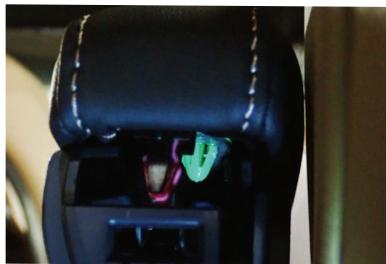
20 斜め下から見ると、黄緑色の留め具が見えます。ツメでフレーム本体に引っかかっているので、マイナスドライバー等でツメを押し込みながらアームレスト後端を押し上げます。かなり固く固定されているので、上記の作業を繰り返して少しずつ押し上げるようにして下さい。
