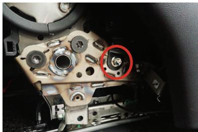
4 ソケットレンチ（14mm）を使用してシートベルトを固定しているボルトを外します。シートベルトは座面の隙間から引き上げておきます。
