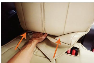
6 座面と背もたれの隙間に生地を入れ込み、背面から引き出します。
