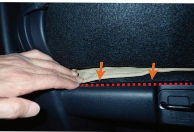
3 入れ込んだ生地を背面側から引き出します。マジックテープが付いた生地をプラスチックカバー上端のラインへ合わせて、シート本体に貼り付けて固定します。
