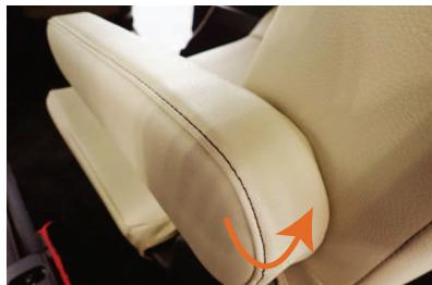
10 アームレストの先端部分からカバーの位置を調整して残りの後ろ側をかぶせます。根本の部分は付属のヘラで形を整えます。
