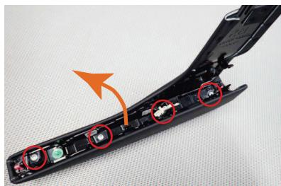
24 アームレストの裏側にあるネジ4か所を外して、裏側の部品を取り外します。
