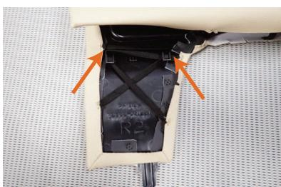
27 カバーに付いているゴムを図の位置のツメに巻き付けて固定します。
