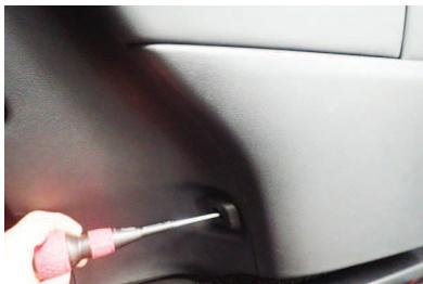
1 カバーをかぶせる前に座席後ろ下のプラスチックカバーを外して、シートベルトを取り外します。最初にシート下の外側に付いているゴム部品をプラスドライバーで外します。
