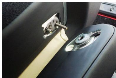
2 ソケットレンチ（12mm）を使用してナットを外します。
