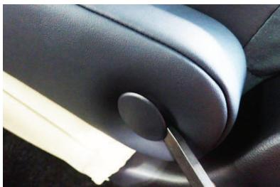
1 背もたれカバーをかぶせる前にアームレストを取り外します。キャップに付属のヘラを差し込んで外します。
