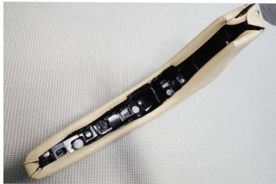
8 23ページ4番で外した部品を取り付け直します。ゴムを押さえるように裏側の部品をはめ込み、ネジを締めます。この後、外側のパネルにカバーをかぶせるので、完成したアームレストは保管しておきます。
