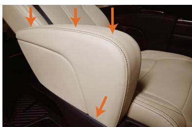
15 アームレスト下のツメと、留め具の位置を合わせて上から押し込み、固定します。
