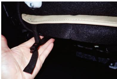
7 シート前側から通したベルトを後ろ側から引き出し、4番で引き出した生地に付いているバックルに固定します。
