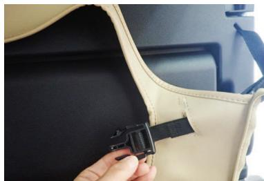
4 シートを跳ね上げて裏面にカバーをかぶせます。シートに付いているシート固定用ベルトをカバーの加工穴から取り出します。
