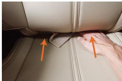
8 背もたれと座面の隙間に生地を入れ込みます。背面側から入れ込んだ生地を引き出します。
