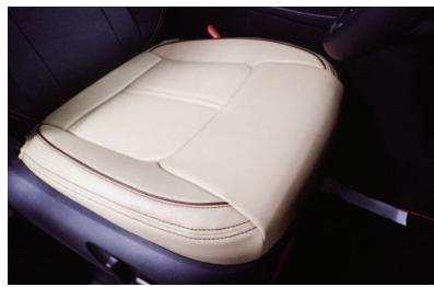
12 カバーのラインを整えて、1列目運転席座面の完成です。助手席側も同様に取り付けます。
