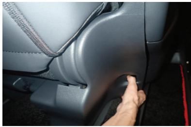
13 2列目背もたれ取り付け時に外した座面下のプラスチックカバーとゴム部品を取り付け直します。
