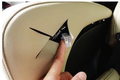
14 2列目ドア側のアームレストを取り付け直します。スイッチユニットのカブラーを取り付け穴から引き出しておきます。
