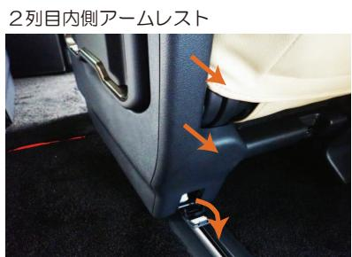
18 2列目内側のアームレストを外します。座面後ろのプラスチックカバーを外します。シートレール付近の蓋に付属のヘラを差し込んで開き、指を入れて引っ張ると外れます。
