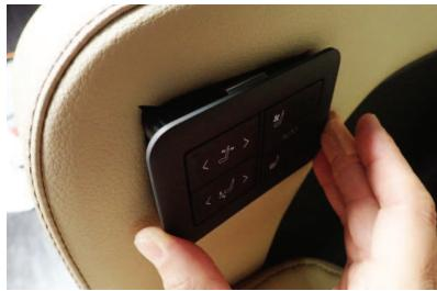
16 スイッチユニットにカブラーを差し込みます。取り付け穴周辺の生地を内側に折り込んで、スイッチユニットを取り付け直します。
