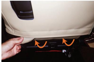
11 1列目の背もたれと同様にカバー側面と中央の生地をシートに馴染ませます。<sup>8番</sup>で引き出した生地に付いているマジックテープを背面側のマジックテープと貼り合わせて固定します。
