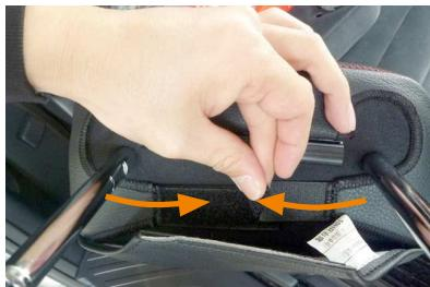
4 ヘッドレストをシートから外します。ヘッドレスト裏で生地を内へ寄せながらマジックテープを固定します。
