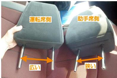
1 助手席スーパーロングスライドシート車は1列目の運転席側と助手席側でヘッドレストの大きさが異なります。軸の幅が広い方が運転席側です。バーツのタグ・カバーとヘッドレストの形状を確認して間違えないように装着して下さい。
