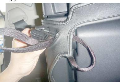
9 シートを跳ね上げた際に車体側に固定するバックルをカバーの加工穴に通します。
