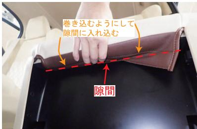
4 フットレストを倒し、カバー前側の生地に付いているマジックテープを巻き込むようにして、シートに直接貼り付けて固定します。貼りつける際、生地の先端が奥の隙間に少し入り込むようにして下さい。
