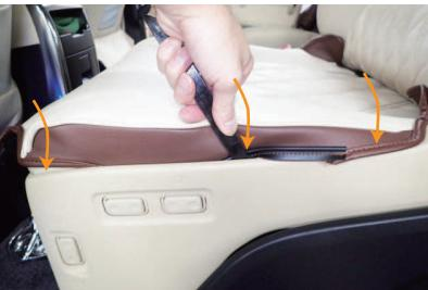
7 ヘラ等を使用し、カバー両側面に付いている固定部材を、シートとプラスチックカバーの隙間に入れ込みます。
