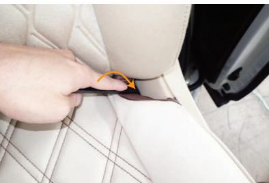
9 カバー両側面の付け根付近に付いている生地を、シートと軸部分の隙間に入れ込みます。
