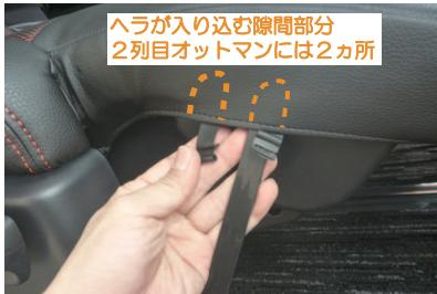
16 オットマン側面の生地裏に、図のような小さい部材が付いています。こちらはオットマンのフチに図のようにへらが入り込む隙間が一部分のみあるので、その隙間に部材を入れ込みます。助手席スーパーロングスライドシートの車は18番もご覧下さい。
