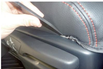
7 カバー側面の生地をシートとプラスチック部のフチに入れ込みます。カバーのラインがシートからはずれないように注意して、内側外側共に入れ込みます。
