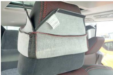
2 カバーの前後を確かめます。カバーは平らなプラスチックが付いている方が前側です。カバーを図のように半分程裏返して、ヘッドレストの先端までしっかりととかぶせます。
