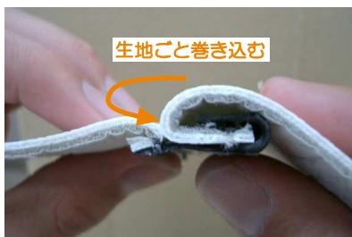
6 プラフックは板状のプラスチックを生地と一緒に折り返して、フック側に巻き込むようにして入れ込み固定します。
