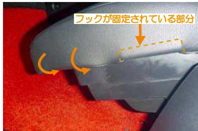
7 フックを固定すると図のようになります。オットマン下周りの生地を内側へ巻き込むように整えます。
