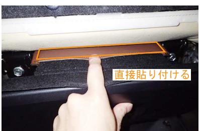
6 引き出した生地に付いているマジックテープを、純正表皮に直接貼り付けて固定します。
