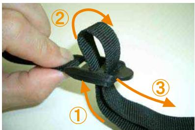
**13** ベルトは①→②→③の手順で、まずバックル中央に通し、折り返してバックルの端に通します。通したベルトを引くとカバーの前後を引き締り固定されます。ベルトは強く引きすぎると、縫製糸が切れてベルトが抜けてしまう恐れがありますので、ご注意下さい。
