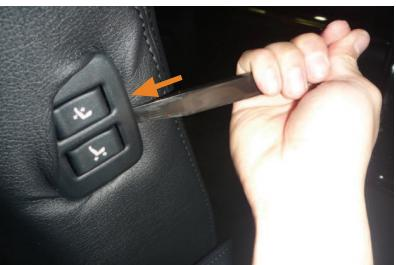
20 助手席側は内側面にパワーシートのスイッチがあります。スイッチのチチにヘラなどを使用して生地を入れ込みます。
