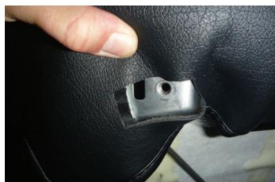
17 アシストグリップ・バックボードを固定する穴の部分を、カバーの加工穴から出します。この状態でバックボードを元通りに固定します
