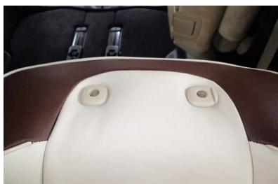
3 カバーの加工穴から、ヘッドレストの台座を取り出します。
