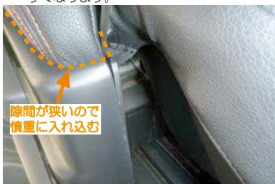
14 生地を入れ込んでいきます。図の点線部分にシートのラインに合わせて生地を入れ込みます。1.3番で開いたプラスチック部は生地を挟み込み固定します。生地を入れ込み過ぎるとツメがはまらなくなるのでご注意下さい。
