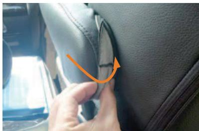
3 軸の部分にカバーを引っ掛けるようにかぶせます。
