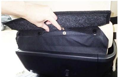
1 始めに、背面下部の純正表皮の固定を外します。純正表皮は、上生地をめくった箇所にある4個のボタンで固定されています。
