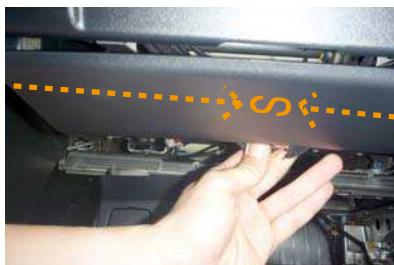
11 オットマンを跳ね上げた裏側をシートの前側から見た図です。図には写っていないませんが、入れ込んだゴムをオットマンの内側から引き出してゴム同士を矢印方向へ引っ張り、金属フックでつなぎ留めます。
