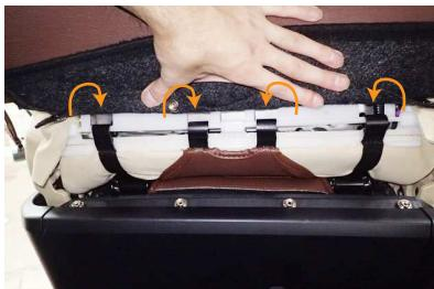
9 29ページ5番で引き出した生地とベルトに付いているフック状の固定部材を、27ページ1番で外した生地裏にあるプラスチックの穴部分に引っ掛けで固定します。
