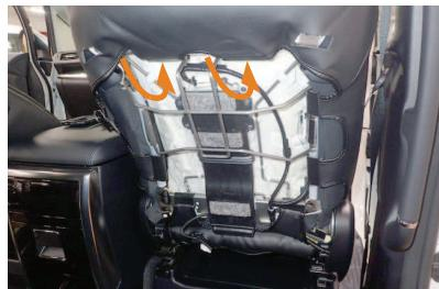
16 カバー背面の上側も、シート表皮を固定しているフックの上からカバーのフックを引っ掛けで固定します。（2カ所ずつ）
