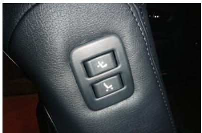
21 助手席側、内側面のパワーシートのスイッチ部分は図のようになります。
