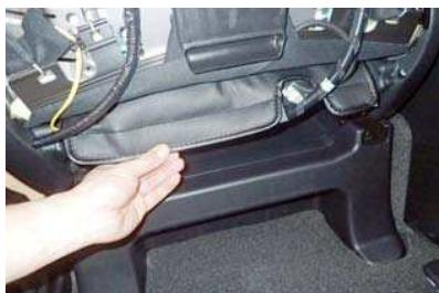
**3** 配線部分に注意してシート背面から生地を引き出します。引き出した生地を直接シートに貼り付けて固定します。
