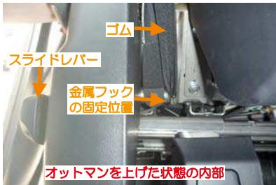
12 もう1本のゴムも9番同様に金属フックを取り付け、オットマン付け根の内側にゴムを真っ直ぐに引っ張り、オットマン内部の金属部分に引っ掛けて固定します。図では固定位置が見えづらいですが、オットマンの動作に干渉しない位置に金属フックを固定して下さい。
