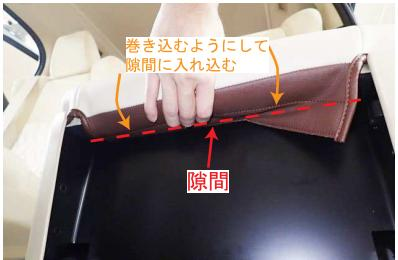
4 フットレストを倒し、カバー前側の生地に付いているマジックテープを巻き込むようにして、シートに直接貼り付けて固定します。貼りつける際、生地の先端が奥の隙間に少し入り込むようにして下さい。
