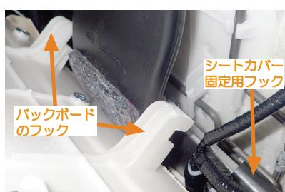
18 バッグボードをシートに戻します。バッグボード下のフックを、金属フレームに引っ掛けます。この際シートカバー固定用フックの上にバッグボードのフックを引っ掛けようとすると、9ページ2番で外したボルトのネジ穴が合わなくなります。シートカバー固定用フックの両端部分をかなり内側に固定していない限りあり得ないのでですが、バッグボードを戻す際はご注意下さい。
