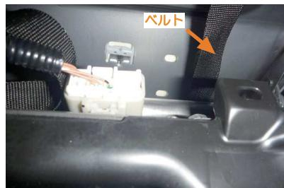
11 7番で引き出したベルトをシートの裏を通ししてシート背面側へ入れ込みます。この際シート裏にある配線や、金属部品の上にベルトを通すようにします。
