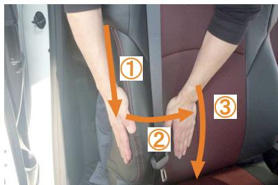
8 カバー側面の生地を①→②→③の順番にシート中央へ集めるようにして馴染ませていきます。生地がシートに馴染むまで繰り返し行って下さい。
