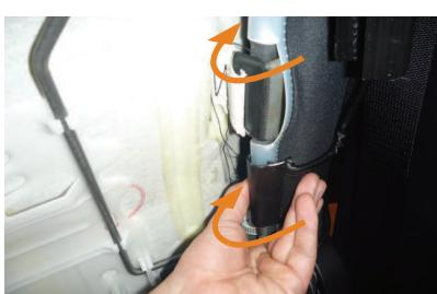
15 カバー背面の両端も、シート表皮を固定しているフックの上からカバーのフックを引っ掛けで固定します。（2カ所ずつ）
