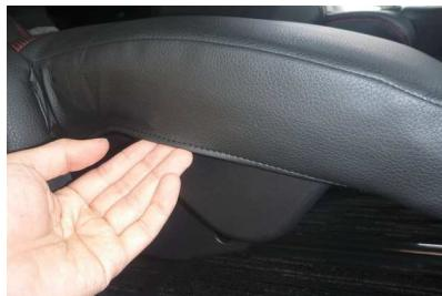
17 ヘラなどを使用して部材を入れ込みます。入り込む隙間は本当に限られた位置にしかありません。カバーの装着や生地の引っ張り具合により、部材と入れ込む隙間の位置にずれが生じます。その場合はカバーの装着を調整して下さい。
