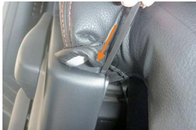
13 オットマン付け根部分のプラスチック部に生地を入れ込みます。生地を入れ込む前に図のプラスチック部の内側にへらなどを差し込むとツメが外れてプラスチック部が開きます。こうすることで生地が入れ込みやすくなります。
