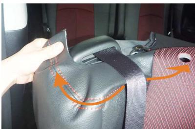
1 背面のファスナーを開けた状態で、肩口のシートベルトをかわして、シートを包み込むようにカバーをかぶせます。
