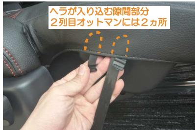
16 オットマン側面の生地裏に、図のような小さい部材が付いています。こちらはオットマンのフチに図のようにへらが入り込む隙間が一部分のみあるので、その隙間に部材を入れ込みます。
