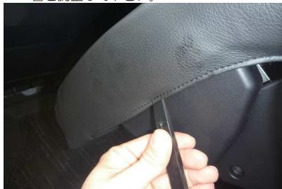
18 部材はへらなどを使用してしっかりと入れ込みます。これによりカバー側面の生地の浮きなどが抑えられます。
