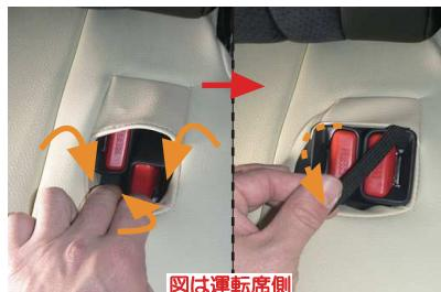
11 シートベルトバックル収納部にカバーの加工穴と位置を合わせて、フチに沿って生地を入れ込みます。入れ込んだ生地をマジックテープで直接シートに貼り付けて固定します。
