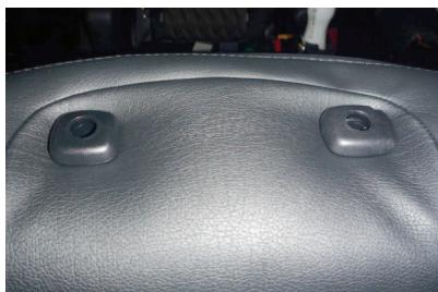
8 生地の伸びを利用して台座を取り出します。一部本革を使用している商品では、生地が裂けてくる場合があります。慎重に作業をしていただければ、台座の大きさ以上に裂け目は広がらないので、作業は慎重に行って下さい。
