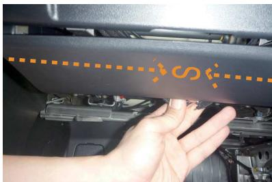
11 オットマンを跳ね上げた裏側をシートの前側から見た図です。図には写っていませんが、入れ込んだゴムをオットマンの内側から引き出でてゴム同士を矢印方向へ引っ張り、金属フックでつなぎ留めます。
