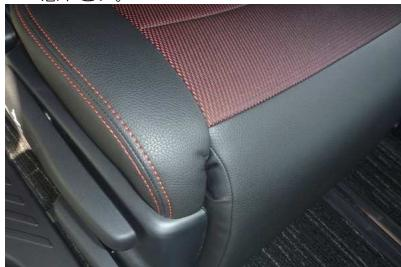
15 生地を全て入れ込むと図のように収まります。先端に生地が余る用だとカバーがシートのラインからずれている可能性があります。その場合はカバーの装着位置を再度調整して下さい。
