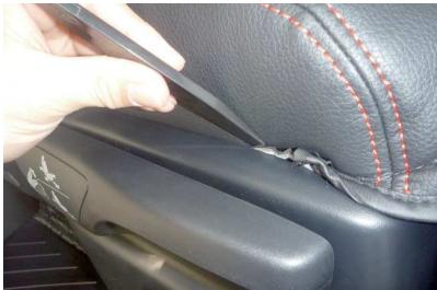
7 カバー側面の生地をシートとプラスチック部のフチに入れ込みます。カバーのラインがシートからずれないように注意して、内側外側共に入れ込みます。
