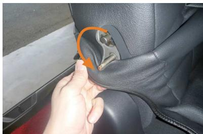
5 アームレスト装備車は、アームレストを外した後の軸部分が突起しているので、カバーをかぶせる際に慎重にかわします。生地を引っ掛けたりすると、破れたり傷が付いたりするので、ご注意下さい。
