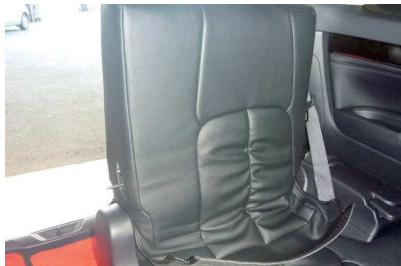
6 シートのラインに合わせて、カバーをシート全体にかぶせます。ヘッドレストの台座をカバーの加工穴から取り出します。
