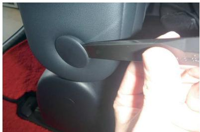
1 アームレストを外します。図のプラキャップをヘラなどを使用して外します。
