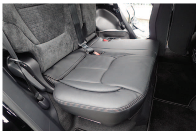
18 カバーのラインを整えて2列目運転席側座面の完成です。助手席側も一部形状は異なりますが同様に取付けます。
