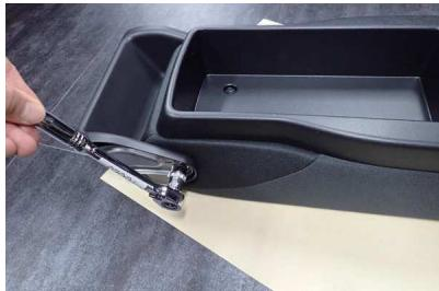
25 アームレストの軸部分のプラスチックパーツを外します。
