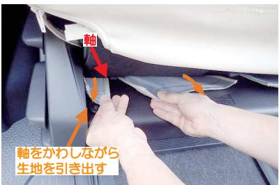
8 生地を引き出す際、一番外側の生地はシートの裏にある軸部分をかわして引き出します。端の方は隙間が大変狭くなっているので、シートの角度を調整しながら作業を行って下さい。
