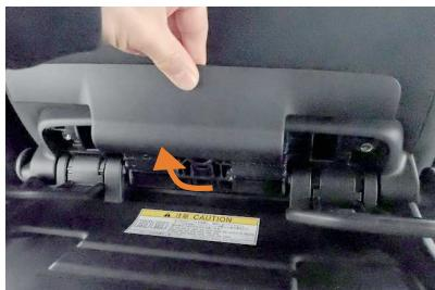
33 軽く押した状態で、付け根部分を手前に引くとプラスチックパートが外れます。
