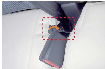
16 カバーの加工穴から1番で外したシートベルトバックルを固定しているベルトの、短い方のみ取り出します。
