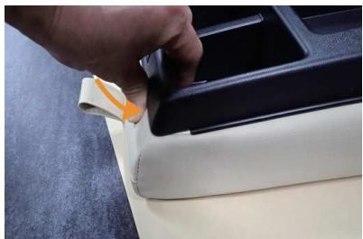
33 32番のフックをアームレストにある金属に引っ掛けることを意識して、アームレストの先端側からボックスを戻します。
