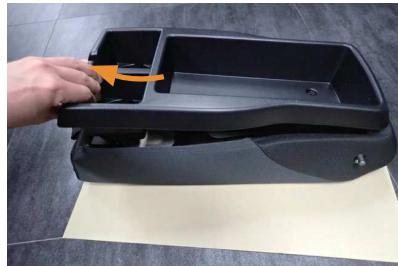
28 ネジを外して、ボックス部分を矢印方向へスライドさせるように引くと、裏のフックが外れてアームレストからボックスが外れます。
