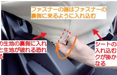
11 ファスナーの端は折り返して、カバー内側のファスナーの裏側（図の赤線部分）に来るように入れ込みます。
