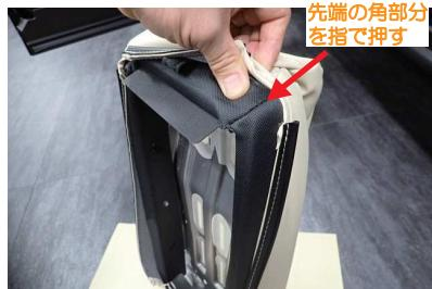
30 付け根側を軸として、カバーをアームレスト全体にかぶせていきます。
