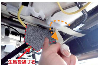
11 引き出したマジックテープをシート裏のフレームに巻き付けて、折り返します。
