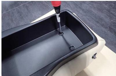
35 ネジを締めてボックスを固定します。
