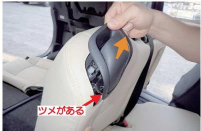
19 レバーはネジと下側のツメで固定されています。ネジを2本とも外すと図のようにシートからレバーが外れます。
