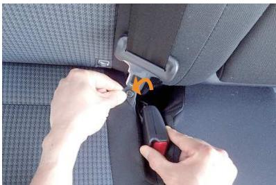
1 運転席側用のシートベルトバックルを固定しているベルトを外します。
