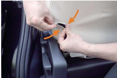
10 シートを跳ね上げた状態で、カバー側面のファスナーを閉じます。
