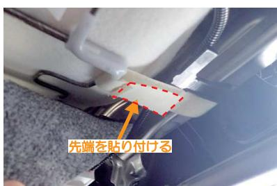
12 折り返したマジックテープの先端に付いているオス部分を、メスのマジックテープに貼り付けて固定します。
