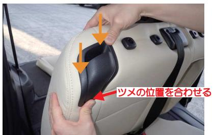
20 外したレバーを生地を挟み込みシートに戻します。
