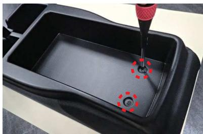
27 ボックス部分の図のネジを、2本ともドライバーを使用して外します。
