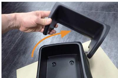
26 プラスチックパーツを矢印の方向へ動かしながら慎重に外します。
