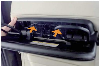
38 シートバックテーブルをシートに固定します。
