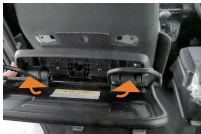
36 下側に力を加えた状態で、テーブルを矢印の方向へ引くと、軸が外れてシートバックテーブルがシートから完全に外れます。
