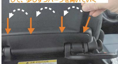
30 次に29番で一部開いたプラスチックパーティの上側からヘラを差し込み、プラスチックパーティを固定しているツメを外していく
