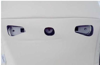
37 運転席と同様にシートカバーを装着します。カバー背面の加工穴の位置と、シートバックテーブルを固定する、軸とボルトの穴位置が合っていることを確認します。穴位置が合っていない場合は、シートカバーの装着がずれています。カバーの装着を見直してください。
