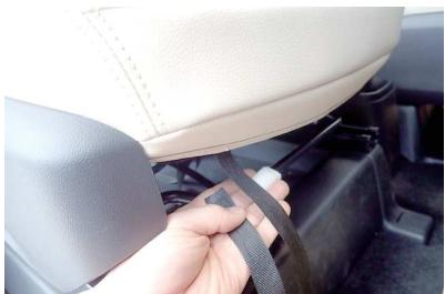
19 シート前側のカバーに付いている3本のベルトを、シート裏を通して背面側へ入れ込みます。
