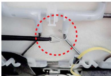
18 金属フックをシート裏のフレームに引っ掛け固定します。
