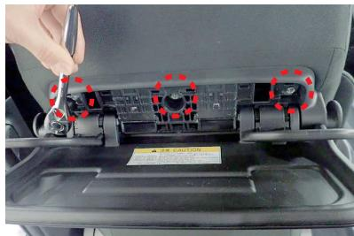
34 プラスチックパートを外すと、シートバックテーブルを固定しているボルトが3本出てきます。
