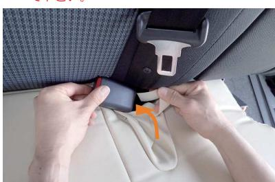
17P ▶ 12 シートベルトバックルが収納される部分の生地の端に、マジックテープが付いています。マジックテープを**6番・7番**で入れ込んだ生地と同様にシートの裏側へ入れ込みます。
