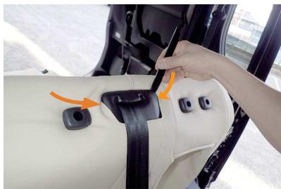
9 中央のシートベルトが出ているプラスチックパーツの隙間に、ヘラなどを使用して生地を入れ込みます。
