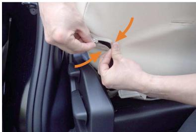
10 シートを跳ね上げた状態で、カバー側面のファスナーを閉じます。生地を内へ寄せながら慎重にファスナーを閉じて下さい。
