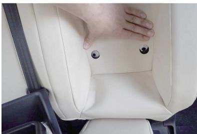
40 アームレストのボルトを通す穴位置とカバーの加工穴の位置が合っていることを確認します。
