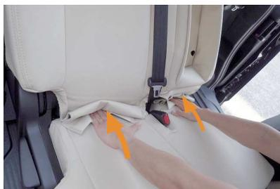
11 背もたれと座面の隙間に生地を入れ込みます。アームレスト下の生地も同様に入れ込みます。
