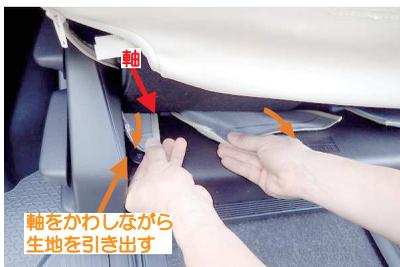
8 生地を引き出す際、一番外側の生地はシートの裏にある軸部分をかわして引き出します。端の方は隙間が大変狭くなっているので、シートを調整しながら作業を行ってください。
