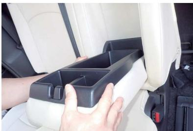
42 アームレストをシートに戻します。ボルト穴とアームレストのボルトの位置を合わせて戻していきます。この際アームレスト収納部の生地が引っ張られたりする場合は、ボルトを固定する前に生地を調整して下さい。
