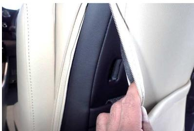
21 コンビニフックのシートの固定位置を確認します。
