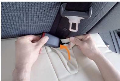
12P ▶ 12 シートベルトバックルが収納される部分の生地端に、マジックテープが付いています。マジックテープを6番・7番で入れ込んだ生地と同様にシートの裏側へ入れ込みます。
