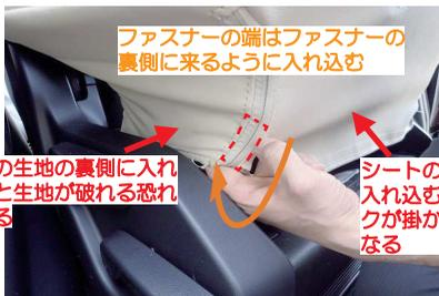
側面の生地裏側に入れ込むと生地が破れる恐れがある
