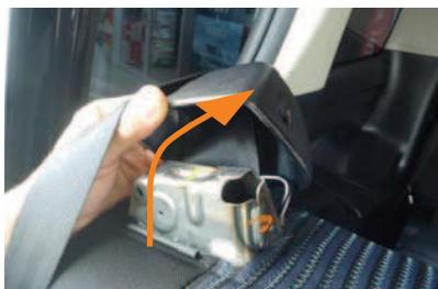
3 プラスチック部は背面側にフックが掛かっているので、矢印の方向へ外します。
