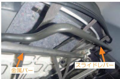
9 カバー前方に付いている3本のベルトを、スライドレバー、シート裏の金属バーの上を通してシート背面へ回します。
