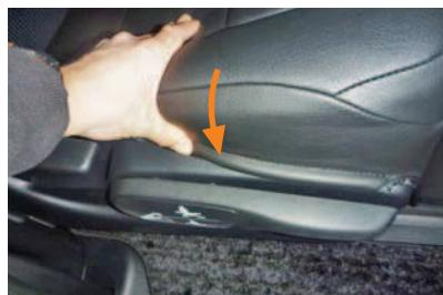
6 カバー外側内側の生地を、シートとプラスチック部の隙間に入れ込みます。
