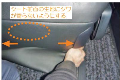
8 図のシート前方のフチに生地をしっかりと入れ込みます。内側外側共に入れ込み、シート前方の生地がしっかりと張るようにして下さい。
