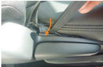
7 外側後方は隙間が狭くなっています。生地を矢印方向へ向けて入れ込むようにすると生地が入り込みやすくなります。
