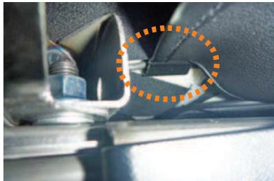
10 フックはシート裏の金属部分に引っ掛けで固定します。シート裏は生地で覆われていますが、その生地を固定している金属部分に引っ掛けで固定します。
