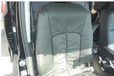
4 カバー両側面のファスナーを開けておきます。カバーをシートのラインに合わせて、シート肩口の生地がしっかりと張るようにかぶせます。
