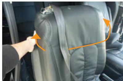
4 カバー背面のファスナーを開いて、シートを包み込むようにかぶせます。カバーはシートベルトの内側を通します。
