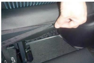
11 8番で引き出した生地とカバー背面の生地を寄せ合いながら、ファスナーを慎重に閉じて固定します。ファスナーの端はカバーの内側へ入れ込みます。
