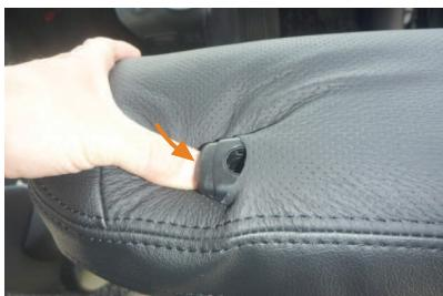
5 ヘッドレストの台座をカバーの加工穴から取り出します。始めに台座の片側のフチに生地をしっかりと入れ込みます。
