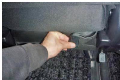
4 引き出した生地をマジックテープで直接シートに貼り付けて固定します。
