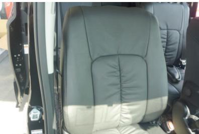
20 サイドエアバッグ装備車は、サイドエアバッグの展開部分とシートカバーのSAB対応の縫い目部分が合っていることを確認して下さい。
