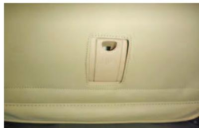
10 図のプラスチック部にカバーの加工穴を合わせるように調節します。
