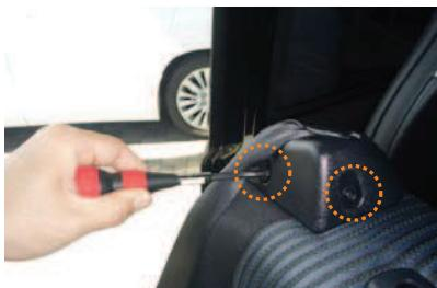
2 シートベルトが出ているプラスチック部を外します。ドライバーで図の位置にあるネジ2本を外します。
