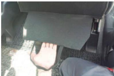
1 始めにシート背面からシート裏に回っている生地を、図のように外します。生地はゴムでシート裏に引っ掛けで固定されています。
