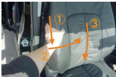
9 カバー側面の生地を、図の①～③の順番でシートに密着させるようにして、シワをなくしていきます。側面の生地がしっかりと張るまで繰り返し行って下さい。
