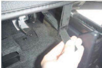
10 シート背面からベルトを引き出して、5ページ4番で引き出した生地に付いているバックルに通します。
