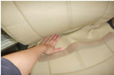
3 座面と背もたれの隙間に生地を入れ込みます。背もたれの角度を調節しながら入れ込みやすい位置で行って下さい。
