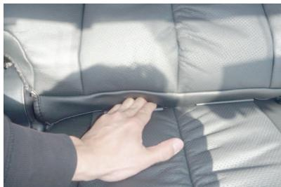
7 背もたれと座面の隙間に生地を入れ込みます。入れ込む生地にカバー固定用のフックが付いているので、生地を入れ込む際は、フックで座面カバーやシート表皮を傷付けないようにご注意下さい。
