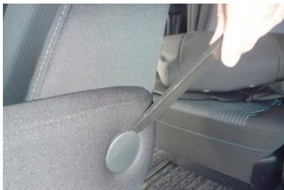
1 始めにアームレストを外します。図のプラキヤップをヘラなどを使用して外します。
