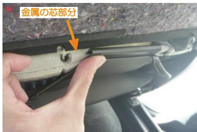
12 8番で引き出した生地に付いているブラフックを、シート表皮を固定している金属の芯部分に引っ掛けで固定します。
