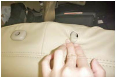
2 カバーの加工穴から生地の伸びを利用してヘッドレストの台座を取り出します。
