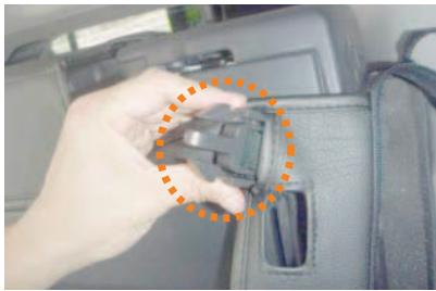
9 シートを跳ね上げて、図の切込み穴からシートを跳ね上げた際に、シートを固定するベルトを通します。ベルトは間違って長方形の穴に通さないようにして下さい。長方形の穴は通したベルトをシート側に固定する際のロック部分に位置を合わせます。
