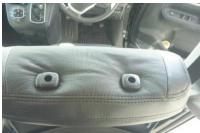
6 生地の伸びを利用して台座を取り出します。革を使用したカバーでは、革が伸びないので、台座を取り出す際、若干生地が裂ける場合があります。少し生地が裂けても台座のフチに隠れますので、作業は焦らず慎重に行って下さい。
