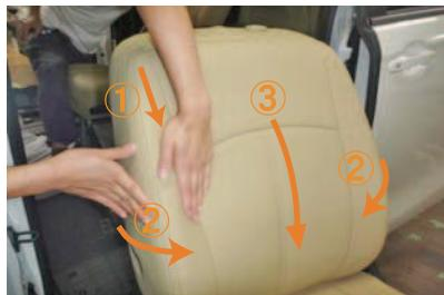
5 カバー側面の生地を、図の①～③の順番でシートに密着させるようにして、シワをなくしていきます。側面の生地がしっかりと張るまで繰り返し行って下さい。
