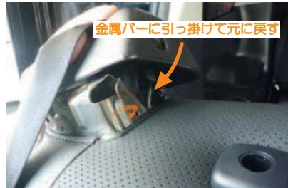
10 プラスチック部を元に戻します。プラスチック部内側の背面にあるフックを、土台側の金属バーに引っ掛け元に戻します。
