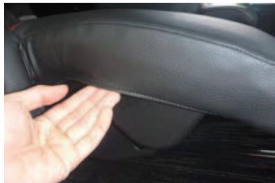
17 ヘラなどを使用して部材を入れ込みます。入り込む隙間は本当に限られた位置にしかありません。カバーの装着や生地の引っ張り具合により、部材と入れ込む隙間の位置にズレが生じます。その場合はカバーの装着を調整して下さい。
