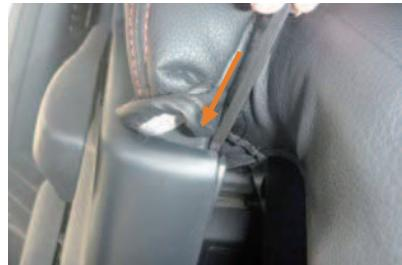
13 オットマン付け根部分のプラスチック部に生地を入れ込みます。生地を入れ込む前に図のプラスチック部の内側にヘラなどを差し込むとツメが外れてプラスチック部が開きます。こうすることで生地が入れ込みやすくなります。
