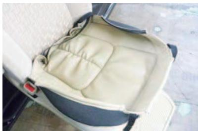
1 リフトアップ機能でシートを外に出し、カバーを図のように裏返して、シートのラインに合わせます。
