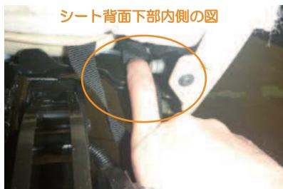
9 17ページ3番で入れ込んだベルトをシート背面下部の左右の隙間に入れ込みます。
