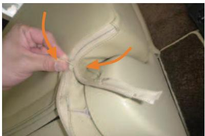
8 アームレスト未装備車のカバーには、内側下面にファスナーが付いています。生地を内へ寄せながら慎重に閉じます。ファスナーの端は、カバーの内側へ入れ込みます。
