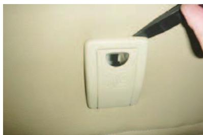
9 シート背面に付いているチャイルドシート固定用アンカーを、ヘラ等を使用し、カバーの加工穴から取り出します。
