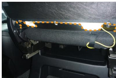
14 10番で引き出した生地に付いているフックを固定します。シート背面下の図の点線部分にフックを引っ掛けで固定します。
