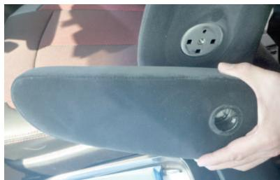
7P ▶ 3 ボルトを外すと図のようにアームレストが外れます。
