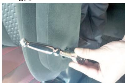
2 アームレストを固定しているボルトを、ソケットレンチなどを使用して外します。ソケットは14mmを使用します。
