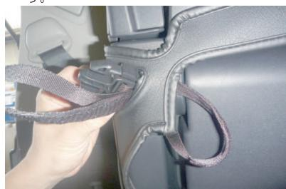
9 シートを跳ね上げた際に車体側に固定するバックルをカバーの加工穴に通します。
