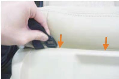
7 シート前面の純正プラスチックカバーとシートの隙間に生地と、生地に付いているベルトを入れ込みます。
