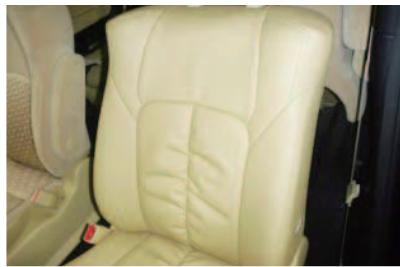
10 カバーのラインを整えて、背もたれが前後に作動するかを確認して、2列目助手席側座面の完成です。
