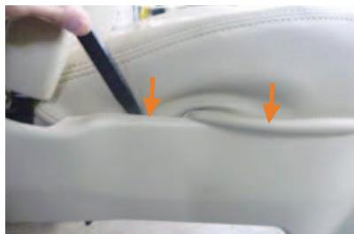
6 シート左右側面の純正プラスチックカバーとシートの隙間に、生地を入れ込みます。
