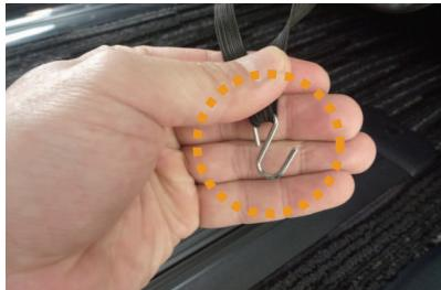
19 カバーの背面下に付いているゴムに付属の金属フックを取り付けます。
