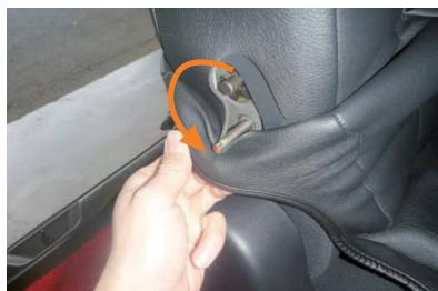
5 アームレストを外した後の軸部分は突き出しているので、カバーをかぶせる際に慎重にかわします。生地を引っ掛けたりすると、切れたり傷が付いたりするので、ご注意下さい。
