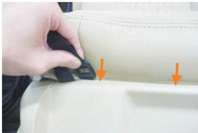
7 カバー前側の生地にはベルトバックルが付いています。ベルトバックルをシートのプラスチック部へ入れ込み、下から引出します。
