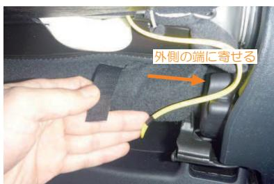
2 1番の生地をめぐり上げた内側に、シート裏で黄色のサイドエアバッグの配線がマジックテープで固定されています。マジックテープを外して、配線を外側の端へ寄せておきます。
