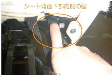
9 19ページ3番で入れ込んだベルトをシート背面下部の左右の隙間に入れ込みます。
