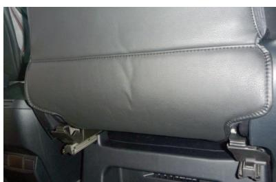
21 金属フックはシート裏の金属部分に引っ掛けで固定します。
