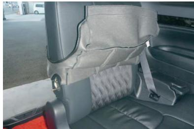
4 カバーを図のように半分程裏返して、シートの先端まで生地が張るように、しっかりととかぶせます。
