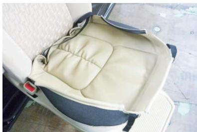
1 リフトアップ機能でシートを外に出します。カバーを図のように裏返して、シートのラインに合わせます。
