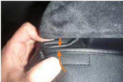
**20** サイドのヘッドレストパーツの角度を調整して、隙間から側面下の生地をマジックテープで固定します。
