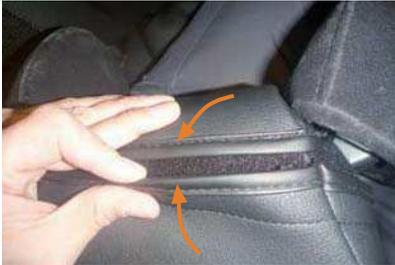
**19** シート全体にカバーをかぶせたら、ヘッドレスト裏でマジックテープを固定します。
