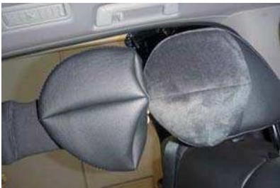
**21** サイド部分を取り付けませす。カバーの向きを確認ませす。ヘッドレストの形状と裏部分の縫い目の位置を見比べてカバーを合わせませす。
