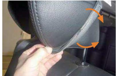
**23** 裏返した生地を慎重にヘッドレスト全体にかぶせませす。生地フチをヘッドレストに引っ掛けるように固定します。
