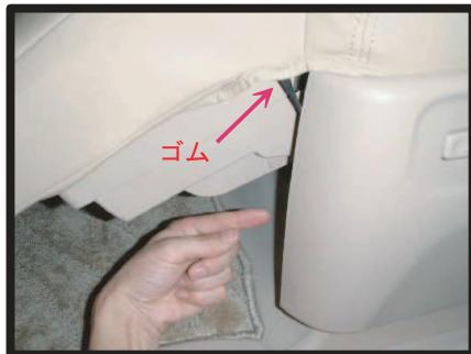
⑥オットマン左右の短い方のゴムは指で示すプラスチックカバーの裏側にS字フックで引っ掛けで固定します。
