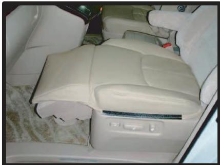
①オットマンを一番上の位置にして座面カバーをかぶせます。シートカバーの後ろ側は座面と背もたれの間を通して後ろから引き出しておきます。
