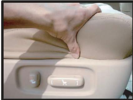
⑤シートカバーを座面本体に馴染ませるようにしながらラインを合わせていきます。側面の生地をシートとプラスチックカバーの隙間に入れ込んでいきます。
