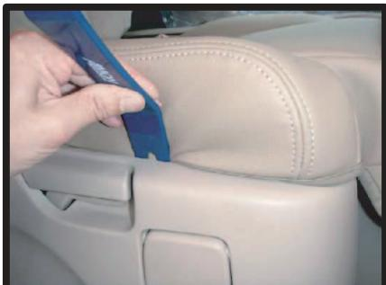
⑤残りの部分はヘラ等で隙間に入れ込みます。隙間が大変狭いので、少しずつ入れ込んでいって下さい。
