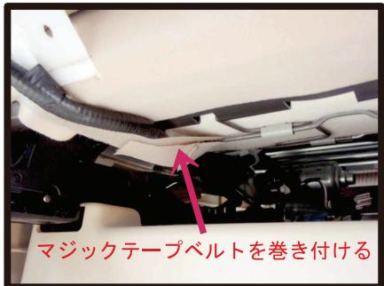
⑦座面後ろ側のマジックテープベルトは、座面下の金属フレームに巻き付けて固定します。
