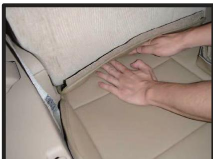
③マジックテープの付いた生地を背もたれと座面の隙間にに入れ込みます。
