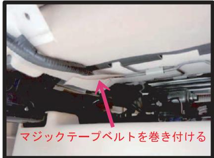
⑧座面後ろ側のマジックテープベルトは、座面下の金属フレームに巻き付けて固定します。
