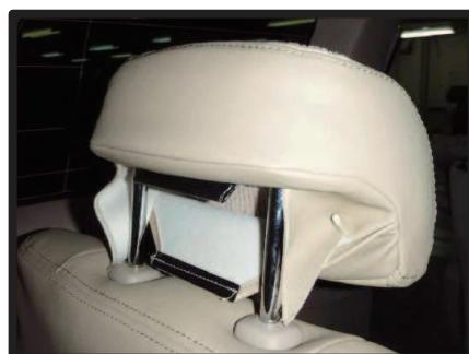
③ヘッドレストを背もたれから取り外し、プラスチックのフックでカバーを固定します。
