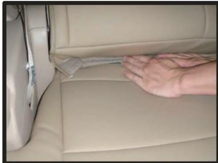
⑦背もたれと座面の隙間に、マジックテープの付いた生地を入れ込みます。
