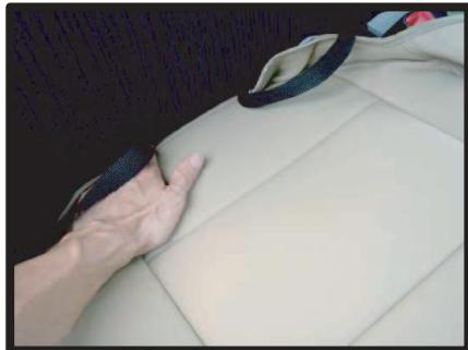
④座面と背もたれの間にシートカバーを入れ込み、後ろ側から引き出します。
