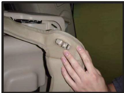
⑧座面上側にあるシート吊り下げ用ベルトを、カバーの切れ込みに通します。
