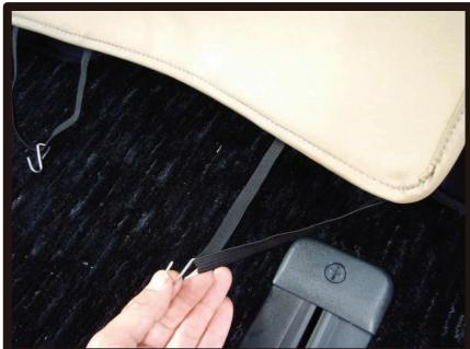
⑨背もたれカバー下のゴムに付属のS字フックを取り付けて、座面下の金属フレームに固定します。純正のカバーはこの部分に覆われる形になります。
