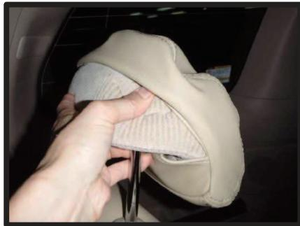
②ヘッドレストカバーを後ろにずらしながらヘッドレスト本体を圧縮して入れ込むようにします。
