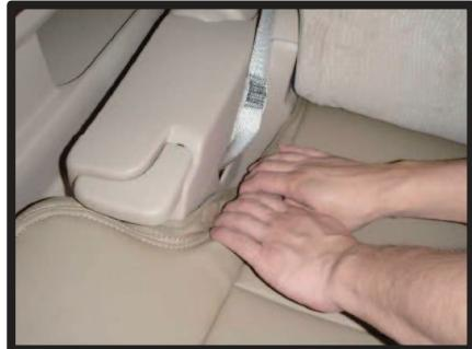
④窓側側面の生地には、マジックテープが付いていますので、図のようにシートの隙間にに入れ込み、シートに直接固定して下さい。
