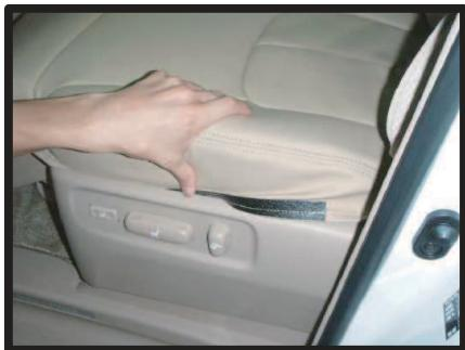
②シートカバーを座面本体に馴染ませるようにしながらラインを合わせていきます。シートカバーの両横に付いている黒い部品をプラスチックカバーの隙間に入れ込んでいきます。
