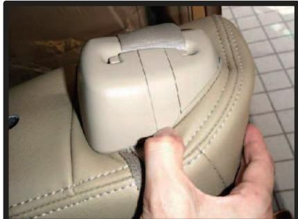
④シートベルト取り付け部分のカバーに生地を入れ込みます。
