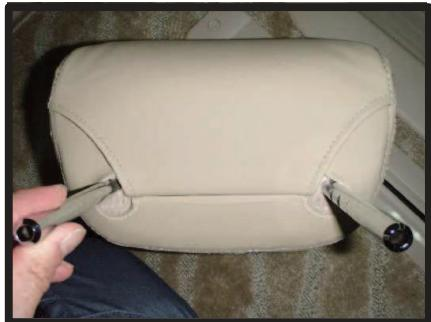
⑥ヘッドレストの底面は写真のように収まります。ヘッドレストを背もたれに取り付け直して完成です。
