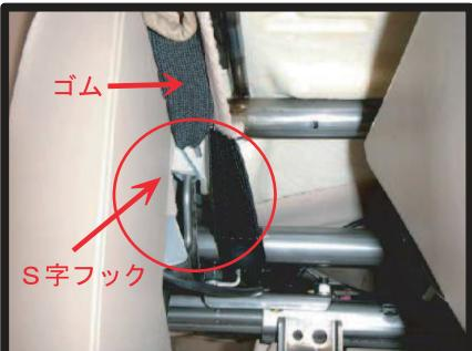
⑧図は⑦の部分を前側下から見た状態です。○印の部分の金属棒にS字フックを引っ掛けて固定します。
