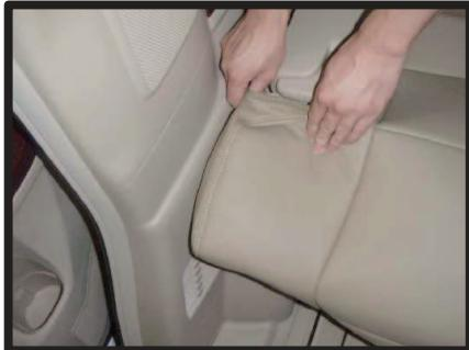
①座面カバーをかぶせます。車体外側の角の部分に引っ掛けるようにしてシートの形に合わせます。
