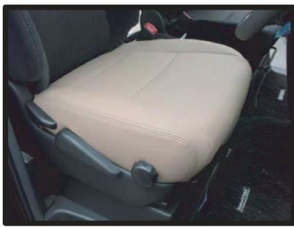
⑨運転席側座面の完成です。助手席側も同様に取り付けます。②で外した純正カバーは背もたれカバー取り付け時までそのままにしておきます。
