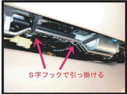
⑦⑥で引き出したゴムに付属のS字フックを付けて、座面下の金属フレームの穴に固定します。
