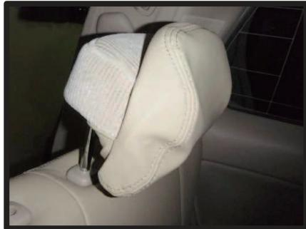
①カバーの前後を確認します。平らなプラスチック部品が付いている方が前です。前側からもぐり込ますようにかぶせます。
