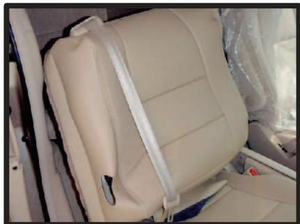
②背もたれカバーをかぶせます。後ろのファスナーを外してシートベルトとシートの間にカバーをくぐらせるようにします。
