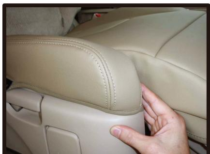
③側面のラインを合わせながら、オットマンとの隙間にカバーを入れ込みます。
