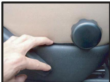
⑥シートカバーの両横に付いている黒い部品を、シートのプラスチックカバーの隙間に入れ込んでいきます。
