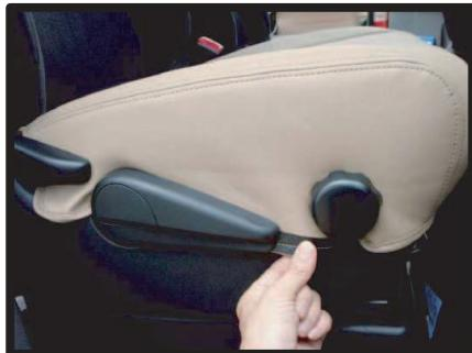
⑤シートカバーを座面本体に馴染ませるようしながらラインを合わせていきます。シートリフター部分はカバーの切り込みに合わせます。
