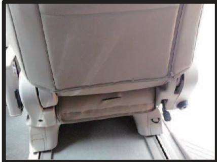
⑧⑥で引き出した部分と背面のマジックテープを固定します。
