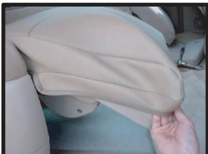
⑥オットマンの先端部分にシートカバーを引っ掛けるようにしてかぶせます。
