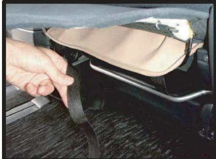
⑦後ろ側のベルトを座面下に通して前側のバックルと固定します。
