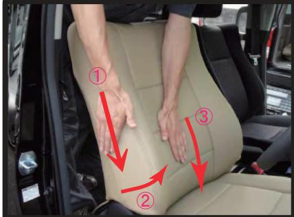
⑦①～③の順番にカバーをなで下ろしてシートに密着させるようにしわをなくしていきます。
