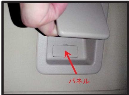
⑧背面のレバー部分を外します。レバーアー奥のパネルの隙間に細い物を差し込んでパネルを外すとネジが見えますので、+ドライバーで外します。
