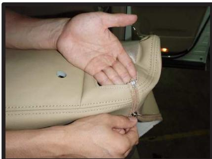
②背面のファスナーを閉じます。左右の生地を寄せながらゆっくりとファスナーを閉じて下さい。カバーからみ出したファスナー部分は、ファスナーを折り返してカバーの内側へ入れ込みます。
