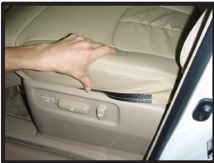
②シートカバーを座面本体に馴染ませるようにしながらラインを合わせていきます。シートカバーの両横に付いている黒い部品をプラスチックカバーの隙間にに入れ込んでいきます。
