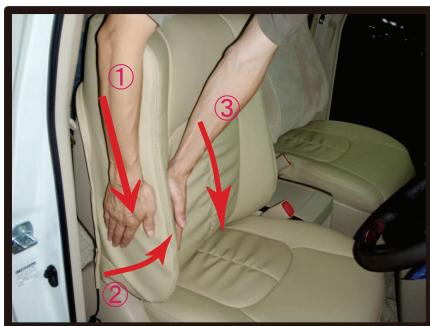
⑤①～③の順番にカバーをなで下ろしてシートに密着させるようにしわをなくしていきます。
