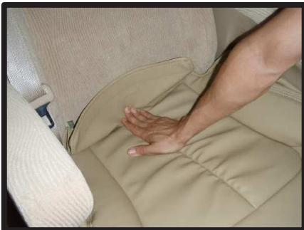
②座面と背もたれの間にシートカバーを入れ込み、後ろ側から引き出します。
