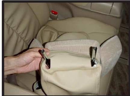
①ヘッドレストをシートから取り外します。シャフトにカバーの穴を通して後ろ側からかぶせます。
