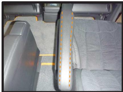
⑦アームレストを真上から見てカバーのラインを確認をします。カバーの縫い目のラインが側面側に寄っている場合や、カバーにズレがある場合は、再度取り付けの調整を行って下さい。
