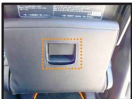
⑥レバー部分の周りはプラスチックカバーに凹みがあるため、カバーは浮きます。カバーの裏側に両面テープを貼る等をしてプラスチックカバー — 21 — に直接貼り付けてください。
