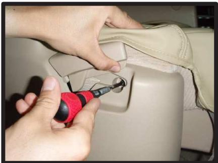
④座面外側のレバーを持ち上げた部分にあるネジを緩めます。
