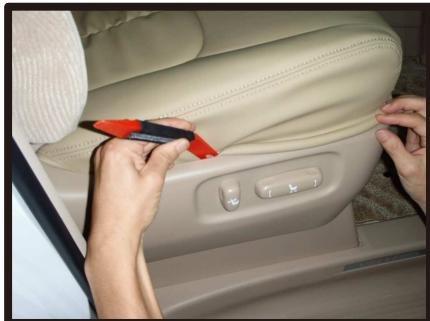
⑦シートカバーを座面本体に馴染ませるようにながらラインを合わせていきます。側面の生地をシートとプラスチックカバーの隙間に入れ込んでいきます。
