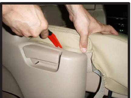
⑥残りの部分はヘラ等で隙間に入れ込みます。隙間が大変狭いので、少しづつ入れ込んでいって下さい。
