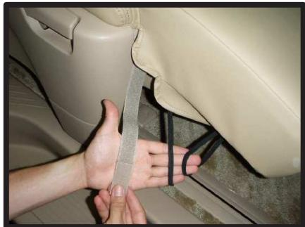
⑦側面部分をすべて入れ込んだら④で緩めたネジを締め直してください。次に、マジックテープベルトとゴムを固定します。
