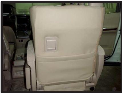
⑩シートカバーをレバー本体で挟み込んだ状態でネジを締め直し、固定します。
