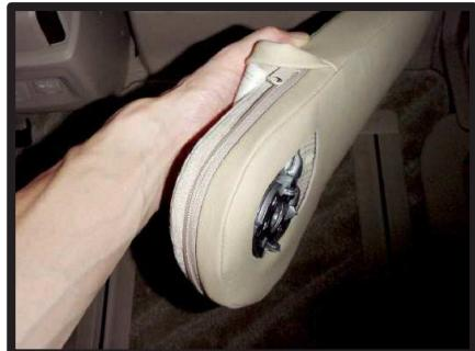
②アームレストはシートから外した状態でファスナーをゆっくり閉めていきます。いったん閉めたファスナーを開けボルトを差し込む方のカバーを外します。
