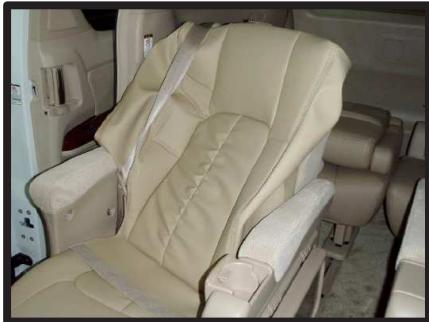
①背もたれカバーをかぶせます。後ろのファスナーを外してシートベルトとシートの間にカバーをくぐらせるようにします。
