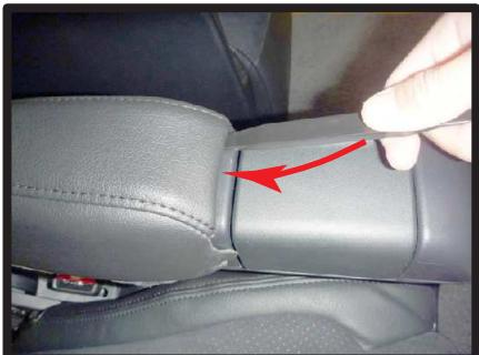
②カバー先端の生地を図の隙間にへらなどを使用して入れ込みます。
