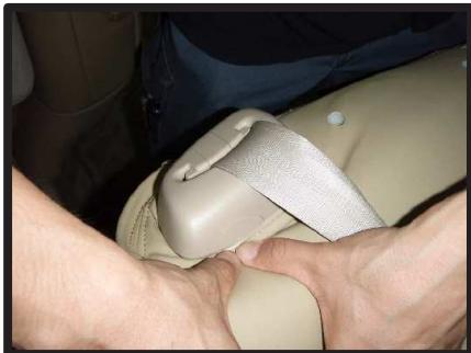
③シートベルト取り付け部分のカバーに生地を入れ込みます。
