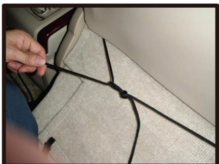
⑨シートカバー背面下のヒモを固定します。片側のヒモで輪を作り、反対側のヒモを通してから絞り込んで結びます。
