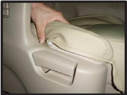
⑤シート両横のラインを合わせながらプラスチックカバーの隙間にシートカバーを入れ込みます。
