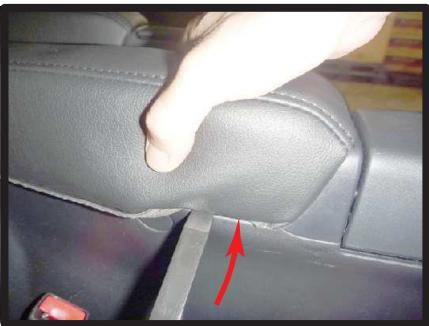
⑤カバー側面の生地を隙間に入れ込みます。この際カバーのラインがずれないようにしっかりと押さえながら作業を行うようにします。また、生地を斜め後ろへ入れ込むようにすると生地が伸びてアームレストの後方で生地が余ります。生地は必ず真上へ入れ込むようにして下さい。
