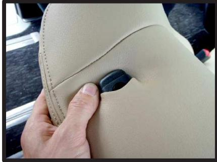
④ヘッドレストの台座部分を穴から取り出します。生地ののびを利用して横からもぐり込みますように取り出して下さい。無理に入れると破れる恐れがありますのでご注意下さい。
