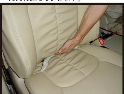
③座面と背もたれの間にシートカバーを入れ込みます。シートカバーにプラスチックの部品が付いていますので、シートカバーや手を傷付けないようご注意下さい。
