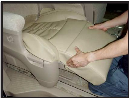
①オットマンを一番上の位置にして座面カバーをかぶせます。オットマンの先端部分からもぐり込ますようにかぶせていきます。
