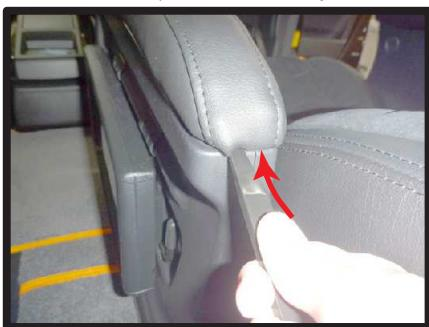
⑥両側面の生地を入れ込んだら、最後にアームレストの後方部分にも生地を入れ込み固定します。
