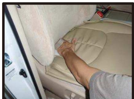
⑤座面と背もたれの間にシートカバーを入れ込み、後ろ側から引き出します。
