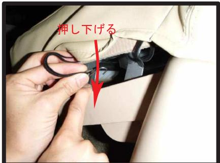
④オットマンの左右に付いている長い方のゴムを、→で示す部品を押し下げながらオットマン内側へ通します。ゴムは2本ある金属の支持棒の間へ通して下さい。
