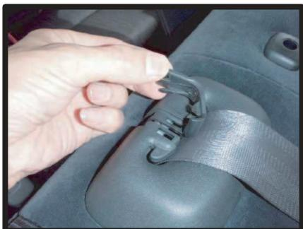
②背もたれ上部のシートベルト取り出し口のカバーも外します。中央の部品にードライバー等を差し込んで外します。残りの部分は持ち上げるようにすると外れます。
