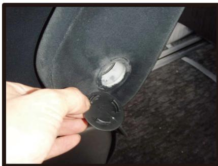
①背もたれカバーをかぶせる前にアームレストを外します。プラスチックのフタを外して中のボルトを外します。
