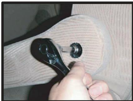
④ソケットレンチ等でナットを外します。アームレストを外すと背もたれから軸が飛び出した状態になりますので、シートカバー取り付けの際は怪我をされないようご注意ください。
