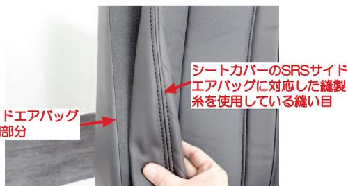
3 サイドエアバッグの展開部分と、シートカバーのSRSサイドエアバッグに対応した縫製系を使用している縫い目の位置（以降SAB対応の縫い目部分）を合わせます。※シートのサイドエアバッグ展開部分にはシートカバーの縫い目が必ず存在します。その縫い目はSRSサイドエアバッグに対応した縫製系を使用しています。
