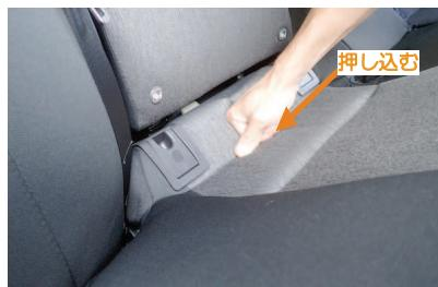
3 シートの後ろ側にもフックが掛かっています。こちらはシートの付け根を押し込み、シートを上向きに角度を少し変えることでフックが外れます。
