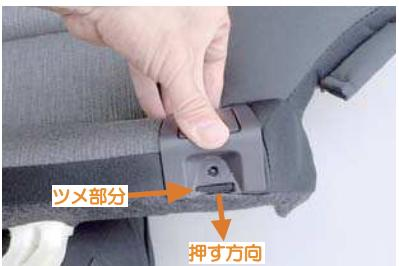
6 プラスチックパーツは5番のネジと後ろ側のツメで固定されています。ネジを外しプラスチックパーツを矢印の方向に押してツメを外します。
