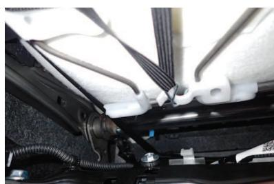
12 金属フックは5ページ1番で外した生地を固定していた、シート裏のプラスチックフックに引っ掛けて固定します。
