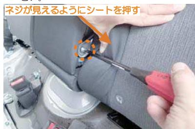
12 プラスチックパーツを外すと中にアームレストを固定しているネジがあります。ネジを助手席側のシートを押しながらプラスドライバーを使用して外します。プラスドライバーは3番の太いサイズを使用します。
