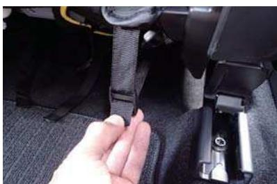
15 ベルトを5ページ6番で引き出した生地に付いているバックルに通して固定します。
