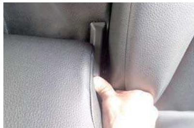
10 軸の金属部分にプラスチックパーツを元に戻します。突起部とツメの位置を意識してしっかりとはめ込みます。
