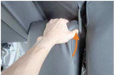
8 プラスチックパーツを外している、金属部分に注意してアームレスト入れ込みます。
