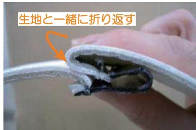
5 プラフックの固定方法は、かぎ状のプラスチックに平らな方のプラスチックを生地と一緒に折り返して、はめ込み固定します。
