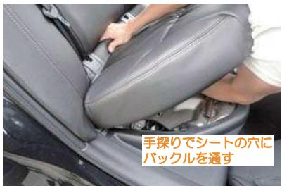
22 図のようにシートの前側を上げた状態で、シートの裏に手を入れて、シートベルトバックルをシートの穴位置に合わせます。次に10ページ2番のフックの位置を合わせます。シートの前側を押し込み固定します。
