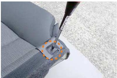
5 チャイルドシート固定用のアンカー周りを覆っているプラスチックパーツを外します。
