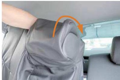
16 カバーの装着を行います。内側のファスナーを開いた状態で、シートと一体型の中央ヘッドレスト部分からカバーをかぶせます。ヘッドレストの形状に馴染ませるように、しっかりととかぶせて下さい。
