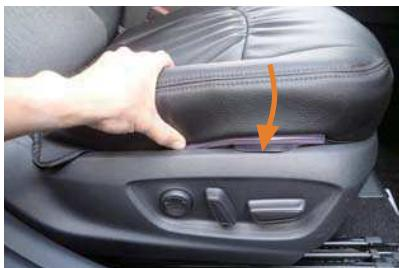
8 外側面の固定部材の付いた生地を、シートとプラスチック部の隙間に入れ込み固定します。
