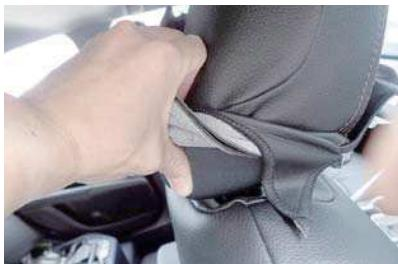
2 ヘッドレストのラインからずれないようにカバーをヘッドレスト全体にかぶせます。ヘッドレストは下側にいくにつれ、カバーをかぶせるのがきづくなっています。指でヘッドレストの角を押しながら、カバーをかぶせます。
