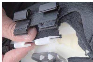
6 サイドパーツのカバーは純正シート地を固定している部分を利用して、カバーの装着を行います。純正シート地を固定している白いフックを図のように外します。
