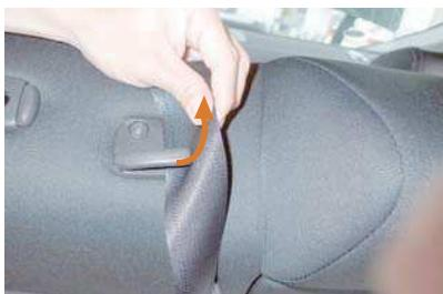
8 2列目中央のシートベルトを、シートベルトのガイドから抜き出します。
