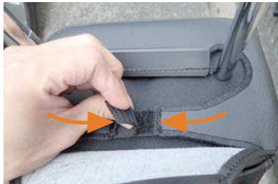
3 ヘッドレストをシートから外して、ヘッドレストの裏側で生地を内へ寄せながらマジックテープを固定します。
