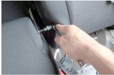
13 16ページ12番で、ドライバーではネジが固くて外れなかった場合は、ソケットレンチなどで使用できる、ドライバービットソケット（ソケットレンチに差しめるドライバー）を使用して下さい。ネジを外しやすくなります。
