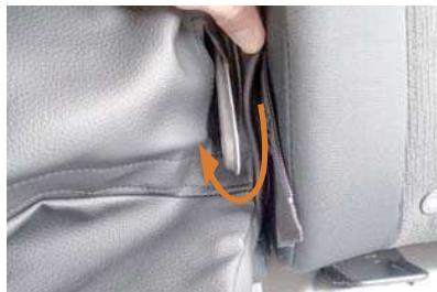
17 アームレストを外した軸部分に、カバーの加工穴を通します。
