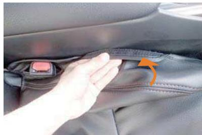
10 内側面の生地の端にマジックテープが付いています。内側面の生地をシートとコンソールボックスの隙間に入れ込み、マジックテープを直接シートに貼り付けて固定します。
