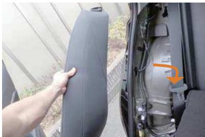
7 上に持ち上げた状態で、手前に引くとサイドパーツが外れます。矢印の方向へシートを一旦内へ寄せながら外します。まっすぐ手前に引くと、サイドパーツの外側に付いているフックが、ウェザーストリップに引っ掛かる恐れがあるので、ご注意下さい。サイドパーツの装着方法は23ページからご確認下さい。
