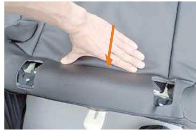
15 シートを表側に戻します。図のようにシートの付け根を押さえて、生地がシートから浮いて、突っ張っていないか確認します。少々生地は浮きますが、生地が突っ張るほど浮いている場合は、1番で固定したベルトを強く締めすぎているので、少し緩めて調整して下さい。
