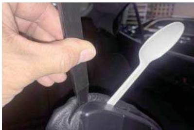
7 スプーンで隙間を保つつつ、始めに差し込んだヘラを取り外して、隙間に生地を入れ込んでいきます。この作業をコンソールのフタ全体に行っていくと作業が行い易くなります。
