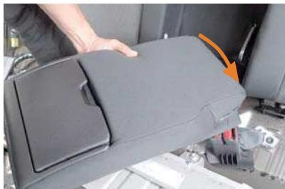
14 ネジを外すとアームレストがシートから外れます。図の矢印方向へアームレストの付け根部分をゆっくり引いていくと図のようにアームレストが外れます。
