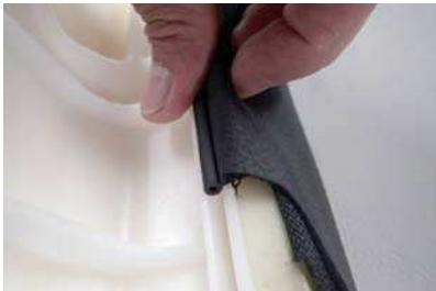
14 純正のシート地を固定していた隙間に、カバーの端に付いている、先が丸い部材を生地と一緒に入れ込みます。部材の丸い部分を先頭にしっかりと入れ込みます。
