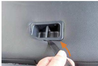
28 シート背面のシートを固定するアンカー部分のフチに、ヘラなどを使用して生地を入れ込みます。
