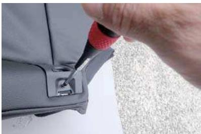
17 プラスチックパートでしっかり生地を押さえて、ネジを固定します。
