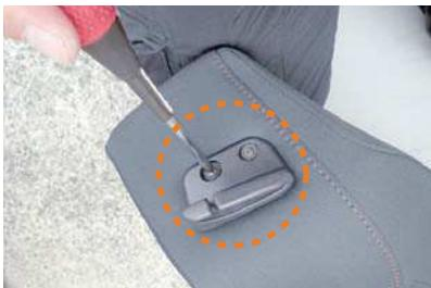
2 シートベルトガイドをドライバーを使用して外します。
