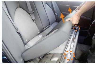
2 シートは図の矢印部分のシート裏にフックで2か所固定してあります。シート裏のフック近くに手をかけて、片側ずつ真上に持ち上げて外します。図の丸印は受け側です。前側のフック2か所が外れると図のような状態になります。フックを外す際は、腰をしっかり入れて、力を込めてシートを持ち上げる必要があります。
