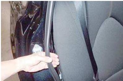
1 15ページ3番でも記載していますが、サイドパーツを装着する際に、図のウェザーストリップを外したり、ずらしたりしてしまう場合があります。ウェザーストリップが外れたりすれたりした場合、水漏れなどが起こる可能性があります。サイドパーツの装着は慎重に行って下さい。
