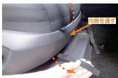
11 カバーの前側にベルトが付いています。図はパワーシート車です。パワーシート車はプラスチックパーツの内側にベルトを通して下さい。
