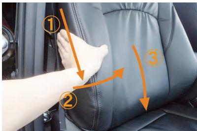
7 カバー側面の生地を、図の①～③の順番でシートに密着させてるようにして、シワをなくしていきます。側面の生地がしっかりと張るまで繰り返し行って下さい。
