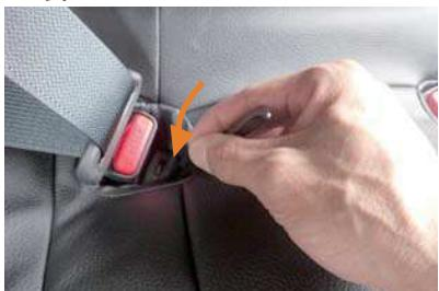
23 シートベルトバックル収納部のフチに、ヘラなどを使用して生地を入れ込みます。この際、シートベルトバックルにシートベルトを差し込んでおくと作業が行い易くなります。
