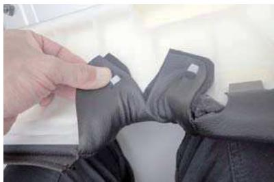
9 内側の下に純正シート地が2か所ツメで引っ掛けで固定されています。その上からカバーも同様に、ツメにカバーの切り込みを引っ掛けで固定します。
