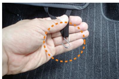
11 カバーの背面下に付いている生地は5ページ1番で外した生地の代わりの役目をします。生地の端に付いているゴムに、付属の金属フックを図のように取り付けます。
