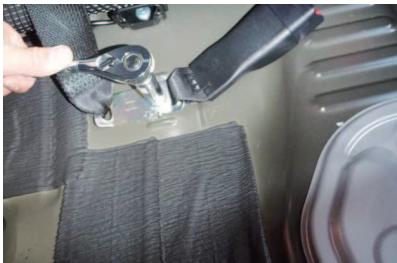
1 車体に固定されている中央のシートベルトをソケットレンチ等を使用して外します。
