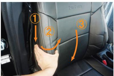
6 カバー側面の生地を、図の①～③の順番でシートに密着させるようにして、シワをなくしていきます。側面の生地がしっかりと張るまで繰り返し行って下さい。
