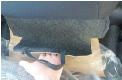
1 始めに背もたれ背面からシート裏に回っている生地を外します。生地はシート裏にゴムで引っかけて固定されています。ゴムの固定をほどき生地を外します。
