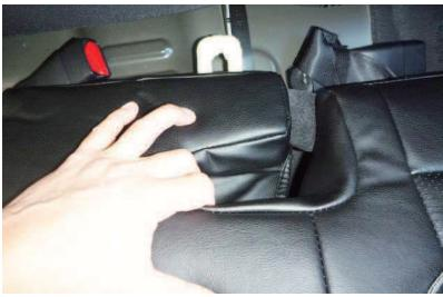
9 シートベルトバックル収納部の生地を、シートの形状に沿わすように馴染ませます。
