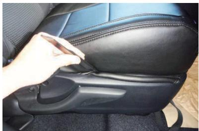
7 カバー外側面の生地を、シートとプラスチック部の隙間に入れ込みます。
