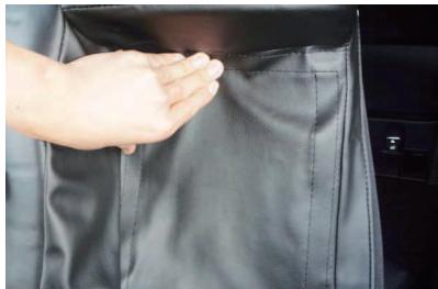
14 アームレスト収納部の生地裏にはマジックテープが付いています。マジックテープをシートの形状に合わせて、生地を伸ばしながら直接シートに貼り付けて固定します。
