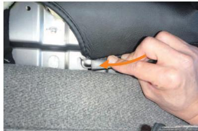
22 シート表皮を固定していた部分にカバーに付いているフックを固定します。カバーのフックは隙間が狭い為フックを固定部の横からスライドさせるように引っかけます。
