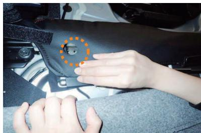
23 フックを固定する際は、カバーの加工穴から12ページ4番で外したピンの穴が見えるよう、位置を調節しながら固定して下さい。
