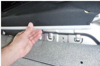
19 背面のシートの純正表皮の固定を外します。純正表皮は図の白いフックで固定されています。このフックの固定を外し、生地部分は折りたたみ、カバーの生地で隠れる状態にします。
