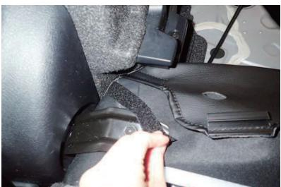
20 14ページ18番で入れ込んだ生地を、シート背面から引き出します。この際、カバー両側面に付いているマジックテープも一緒に引き出します。（助手側は外側面のみにマジックテープが付いています）
