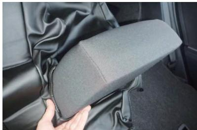
7 アームレストを斜めに倒してカバーの加工穴に通します。
