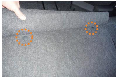
4 次にシート背面下の生地も外します。こちらもピン2箇所で固定されています。ピン周りの生地を掴み、垂直に持ち上げて外します。
