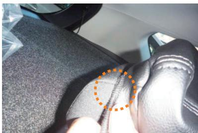
8 2列目ヘッドレスト後ろ側にカバーをかぶせていく際は、図の丸印部分に負荷がかかりやすいので、しっかり生地を馴染ませながら慎重にかぶせて下さい。
