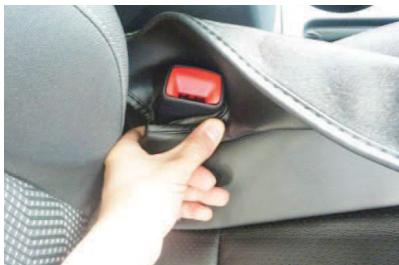
3 シートベルトバックルをカバーの加工穴に通します。
