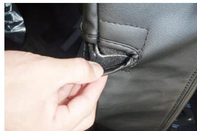
16 シートをロックする部分のフチに、生地をマジックテープで直接貼り付けて固定します。
