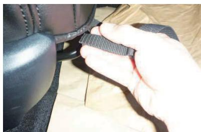
9 カバー前面に付いているベルトを、シート裏を通して背面へ回します。
