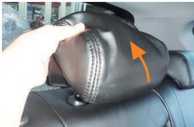
7 2列目ヘッドレストです。2列目ヘッドレストは図の矢印方向に、ヘッドレストのラインに合わせて下から上へかぶせます。カバーは平らなプラスチックが付いている方が前になります。
