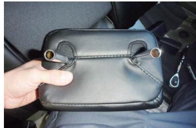
10 こちらは2列目中央ヘッドレストの裏の図です。2列目ヘッドレストはカバーを少しでもかぶせやすくするために、軸周りの穴を大きめに開けています。
