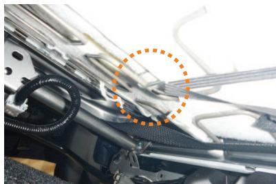
11 金属フックをシート裏の金属部分に引っかけて固定します。
