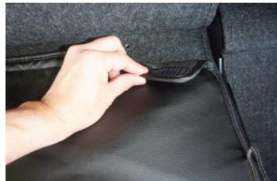
17 カバー背面下の生地を、直接シートに貼り付けて固定します。
