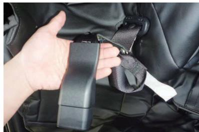
6 背もたれカバーをかぶせます。1番で外したシートベルトをカバーの加工穴に通します。
