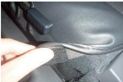
8 入れ込んだ生地をシート背面側から引き出し、9ページ6番で結んだヒモを隠すようにマジックテープでシートに直接固定します。
