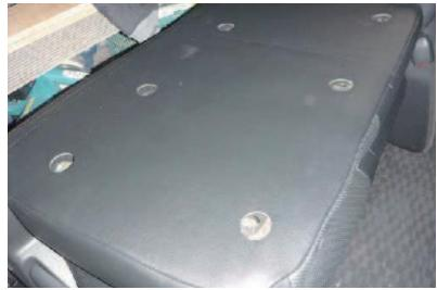
10 シートのネジ穴とカバーの加工穴の位置が合っていることを確認し、バックボードを元に戻します。
