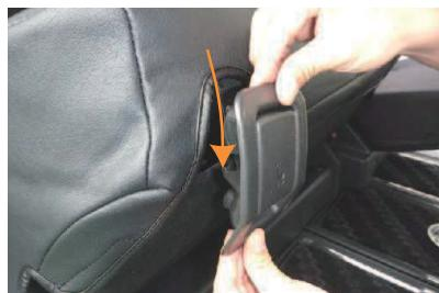
5 ネジを外し、レバーを下へすらすとレバー上側で留まっているツメが外れ、シートスライドレバーを取り外します。
