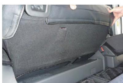
6 カバー前側に付いているマジックテープをシートに直接固定します。
