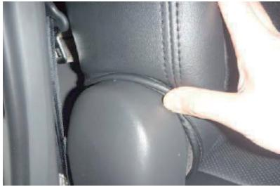
9 シートの付け根部分の生地をシートの隙間に入れ込みます。
