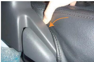
2 カバー側面の生地を、シートの隙間に入れ込みます。
