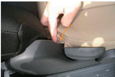
8 矢印部分の生地を図のようにシートの隙間にへ入れ込みます。
