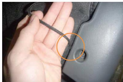
4 カバー側面から出ているヒモを座面後ろ側の○の位置から出します。
