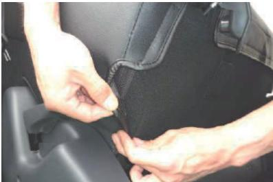
7 カバー側面の生地もマジックテープでシートに直接固定します。
