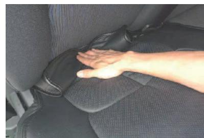
3 背もたれと座面の隙間に生地を入れ込みます。入れ込む生地にベルトが付いていますので、ベルトが座面下にまわるようにします。
