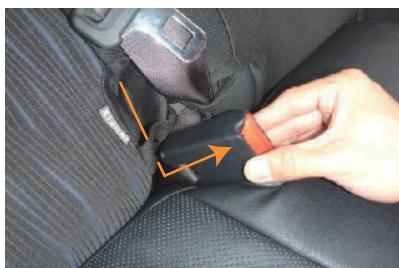
1 シートに生地で固定されているシートベルトバックルをシートの下側へ引き抜きます。図の矢印のようにシートの下側へ押し下げてから引き抜きます。
