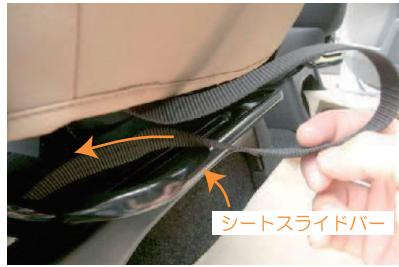
10 カバー前側にあるベルトは、シートスライドバーをかわしてシートの後ろ側へ出します。
