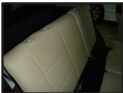
⑨カバーのラインを整えて2列目背も たれの完成です。 助手席側も一部形状が違いますが、 同様に取付けます。
