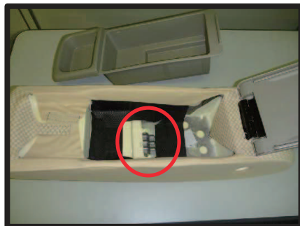
②図の赤丸部分がボックス裏側に引っ かかっているので、ボックスを前側 にスライドさせて外します。
