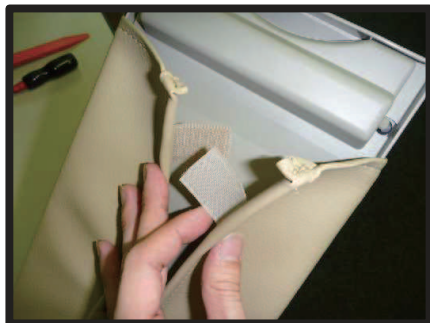
⑬生地を巻き付け、左右に付いているマジックテープで固定します。
