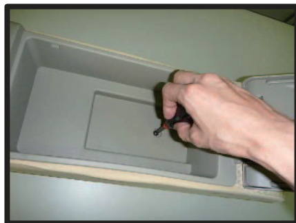
①最初にボックス内にあるネジをドライバーで外します。
