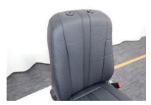
7 説明書に従って、シートカバーを正しく取り付けます。 サイドエアバッグ展開部分とSAB対応の縫い目部分が合っているか確認します。
