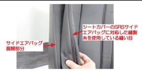
3 サイドエアバッグの展開部分と、シートカバーのSRSサイドエアバッグに対応した 縦製糸を使用している縫い目の位置(以 降SAB対応の縫い目部分)を合わせます。 ※シートのサイドエアバッグ展開部分には シートカバーの縫い目が必ず存在します。 その縫い目はSRSサイドエアバッグに 対応した縫製糸を使用しています。
