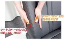
9 次に、シートカバーの表面側と側面側の生地を図のように引き伸ばし、カバーのSAB対応の縫い目部分が、サイドエアバッグの展開位置となる角ばった形状(2番参照)の角に位置することを確認します。この位置が合っていれば、シートカバーは正しい位置に装着されています。SAB対応の縫い目部分が側面側にずれていたりすると、サイドエアバッグの展開部分と位置が合っていない場合はカバーの装着を物り直してください。
