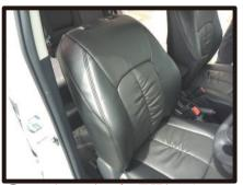
⑭サイドエアバッグの展開部分とシートカバーのSAB対応の縫い目部分が合っていることを確認して下さい。シートのラインを整えて、1列目背もたれの完成です。 助手席側も同様に取り付けます。
