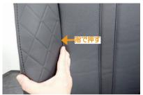
8 まず、シートの表面の中央と端の境目になる縫い目を指で押して、シートのくぼみにカバーの縫い目がしっかりと合っているかを確認します。
