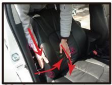
⑧1~③の手順で側面のシワをシート中央に寄せて、そのまま下になぞるようにカバーをシートに馴染ませていきます。シート側面のシワが無くなるまで続けて下さい。
