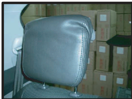
⑦3列目ヘッドレストは下部分からカバーを入れ込んでいきます。
