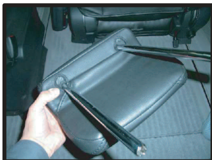
⑧ヘッドレスト本体の後ろ側を圧縮しながら全体を入れ込みます。カバーの位置を調整してから、1列目と同様にプラスチックフックで固定します。
