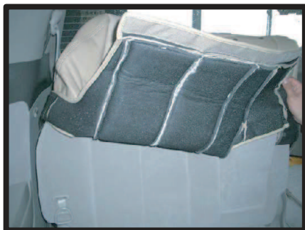
①シートカバーを半分ほどで裏返しライニングを合わせ被せていきます。
