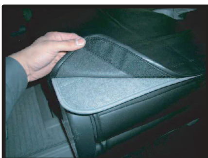
⑥背もたれカバー裏側をマジックテープで固定します。
