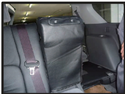
①カバー側面のファスナーを開けた状態でシートにかぶせます。
