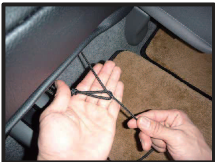
㉑もう片方のヒモをその輪に通して引きます。座面下回りが絞り込まれ固定されます。ヒモは強く引きすぎると切れますので、ご注意ください。またヒモを結んだ後にシートを前後にゆっくりスライドさせて、ヒモがシートレールに干渉していないか確認して下さい。
