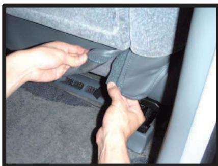
⑥引き出した生地を④で引き出した生地のマジックテープで固定します。反対側も同様に固定します。
