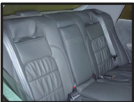
㉔背もたれを車体に戻します。パワーシートのコネクタを付け忘れないようご注意ください。外したときと逆の手順で固定します。
