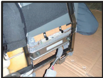
㉒アームレストを背もたれに戻します。外した時と逆の手順で固定します。図を参考にコネクタを引き出す位置にご注意下さい。
