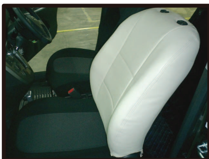
⑫サイドエアバッグ装備車は、サイドエアバッグの展開部分とシートカバーのSAB対応の縫い目部分が合っていることを確認して下さい。カバーのラインを整えて1列目背もたれの完成です。反対側も同様に取り付けます。
