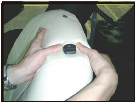
⑩ヘッドレストの台座部分を穴から取り出します。生地伸びを利用して横からもぐり込ますように取り出して下さい。無理に入れると破れる恐れがありますのでご注意ください。
