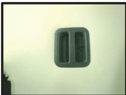
⑪①で外しておいた取っ手を外した時と逆の手順で、カバーの上から取り付けます。
