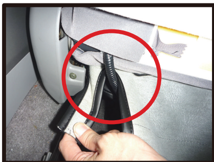
⑧引き出した生地にある隙間でコードをかわします。
