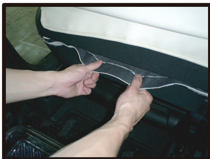
⑦入れ込んだ生地を背もたれ背面から引き出します。
