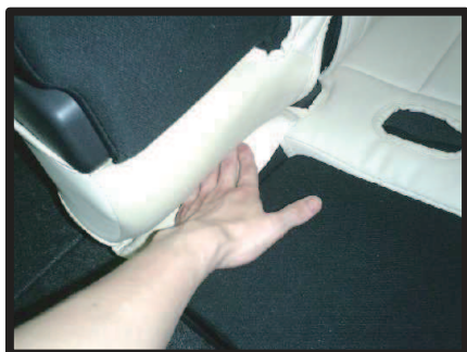
⑨アームレスト下の生地（下側）を隙間に入れ込みます。
