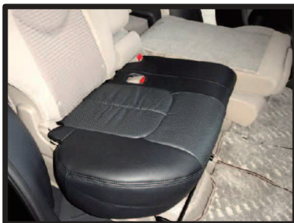
⑩カバーのラインを整えて2列目座面の完成です。 助手席側も一部形は違いますが、同様に取り付けます。
