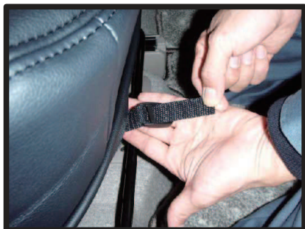
⑦前後のベルトを座面の前側で締め込み固定します。
