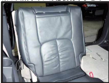
①最初に、ヘッドレストを外します。 ヘッドレストの台座とカバーの穴位置を合わせてカバーをかぶせます。
