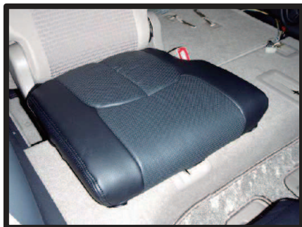
⑧カバーのラインを整えて3列目座面の完成です。 助手席側も同様に取り付けます。
