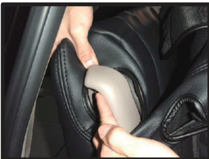
②カバーはシート肩口に付いているレバー部分からかぶせます。レバーをカバーの穴から取り出し、肩口までしっかりかぶせます。
