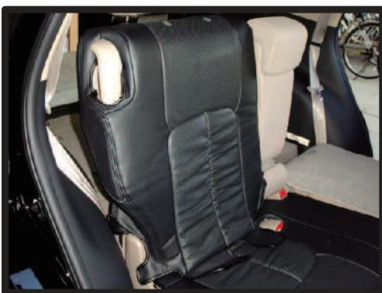
③反対側の肩口もしっかりかぶせてから、1箇所にかが集中しないようカバーを左右均等に下まで引き下げていきます。
