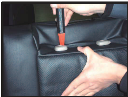
②ヘッドレストの台座部分を穴から取り出します。入れ込みにくい場合はヘラ等を使用して下さい。
