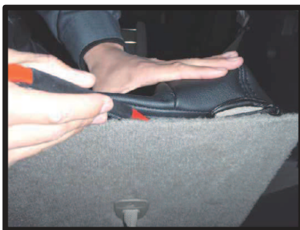
③背もたれ上側の生地をシート本体のクッションと背面パネルの間に入れ込みます。
