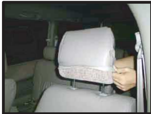
①ヘッドレストカバーを被せていきます。ヒモが出ている方を前にしてヘッドレストを圧縮しながら入れ込んでいきます。
