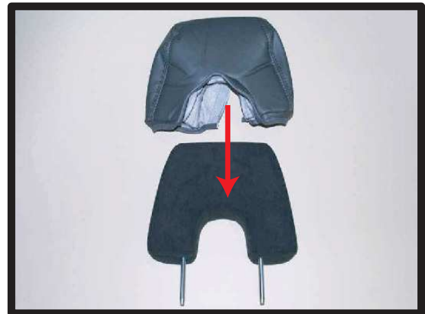
①左右均等にヘッドレストカバーを被せていきます。
