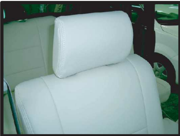
⑥ヘッドレストをシート本体に取り付けて完成です。
