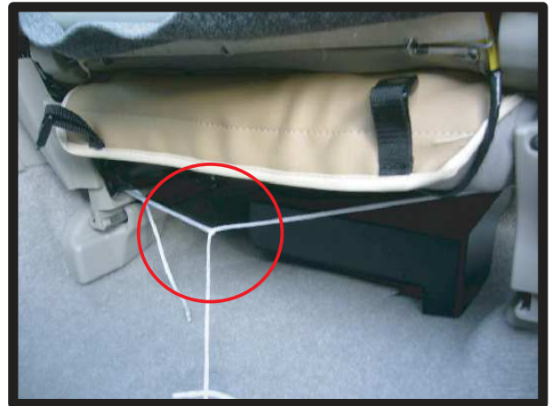
⑤手順③で抜き出しておいたヒモを、片側のヒモで輪を作り、もう一方のヒモを輪に通して、適度な力で引っ張り、結んで固定します。 ※引っ張り過ぎに注意してください。
