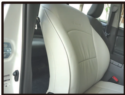
⑪⑧～⑩の作業を繰り返して行なうことで、シート側面のカバーがたるみ無くシートに馴染みます。
