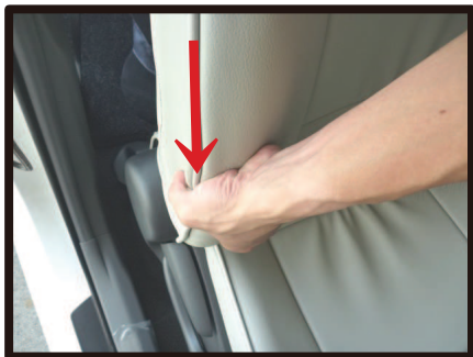
⑧シート側面の張り出し部分です。カバーをシートに馴染ませます。始めに矢印方向へカバーを撫で下ろします。
