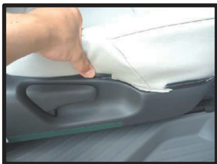
⑮カバー側面のプラスチックをシートとシートの土台のプラスチック部の隙間に入れ込みます。
