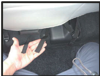
⑱6ページの⑥で通したベルトをシート前方から引き出します。引き出したベルトは、シート前方のバックルに通して固定します。
