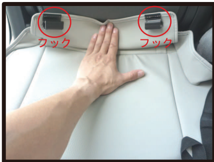
⑨背もたれと座面の隙間に生地を入れ込みます。生地を入れ込む際に、部材のフックでシート地を傷付けないようにご注意ください。
