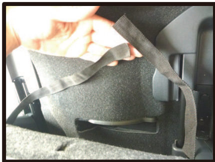
⑥③④⑤で入れ込んだベルトを、シートを前方にスライドさせて、シートの背面から引き出します。引き出したベルトはシート裏を通して、シートの方へ回します。
