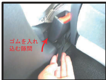
㉑助手席側のカバーには、シートベルトバックル収納部分の生地下に、ゴムが付いています。ゴムはシート裏に引き出して、シート裏に引っ掛け固定します。運転席側のカバーとの違いは、助手席側には内側面のフックは付きません。その他は同様に固定して、取り付けを行って下さい。
