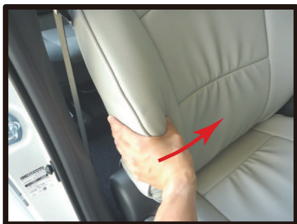
⑨⑧の作業でカバー側面下に余った生地を、今度はシートの中央へ寄せていきます。
