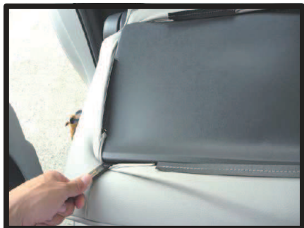
⑧シート背面のバックボードの隙間に生地を入れ込みます。プラスチックの板を入れ込むことで、生地がはみ出さずに固定されます。
