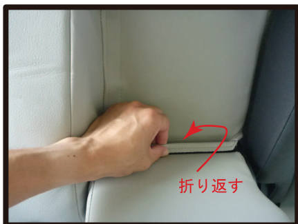
⑤カバーをプラスチックフックで固定します。アームレストを倒した際に上になる生地を折り返して、④で引き出した生地に挟むようにします。
