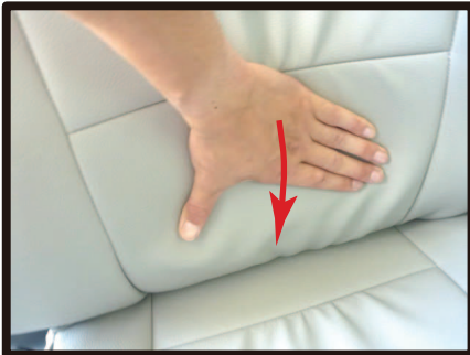
⑩シートの中央へ寄った生地を、シートに密着させるように撫で下ろします。ここで3ページの⑤で引き出した生地を再度引き直すと、余った生地がシート背面から引き出され、カバーがよりシートに馴染んでいきます。
