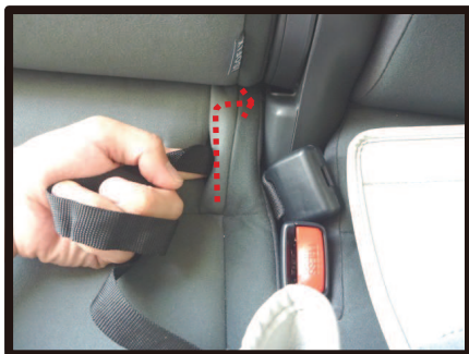
④内側の穴にもベルトを通します。内側はベルトが底に当たると、向かって右側へベルトを寄せます。
