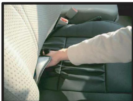
③座面と背もたれの間のカバーをしっかりに入れ込みます。その後、座面の輪郭ラインに合わせたまま座面全体にカバーを被せていきます。
