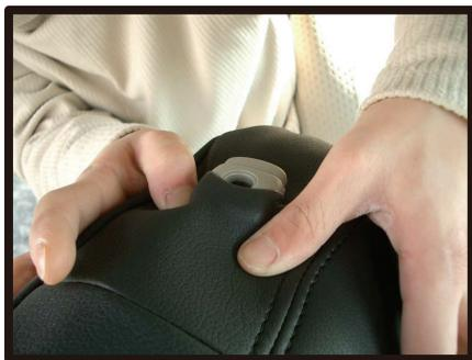
④ヘッドレストの台座部分を穴から取り出します。生地のをびを利用して横からもぐりこまずように取り出して下さい。
