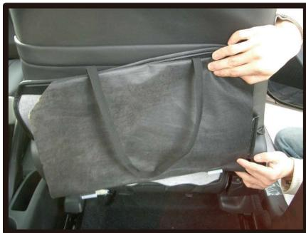
⑥座面裏についていたカバーを不織布の部分を内側に折り曲げて、座面裏に引っ掛けます。
