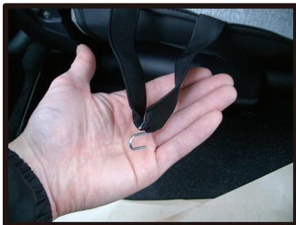
⑤②で入れ込んだゴムの部分を後ろから引き出します。そしてゴムに付属品のS字フックを取り付けて、ゴムを伸ばしながら座面の裏に引っ掛けます。
