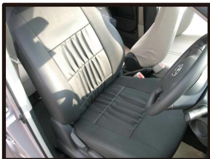
⑧サイドエアバッグ装備車は、サイドエアバッグの展開部分とシートカバーのSAB対応の縫い目部分が合っていることを確認して下さい。
