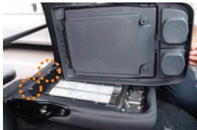
2 バックテーブル後方にもネジが2ヶ所あります（図の○位置）。4ヶ所のネジを外す事で、バックテーブルが取り外せます。
