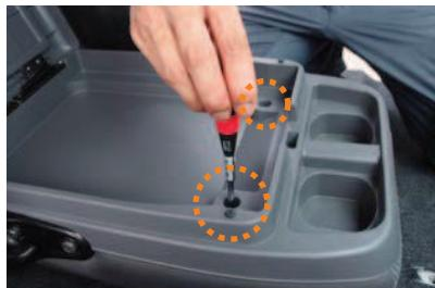
1 中央席背もたれを倒し、バックテーブルを外します。バックテーブルのフタを開け、図の○位置の2ヶ所のネジをプラスドライバーを使用し外します。
