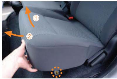
5 シートは図の○位置にある固定具で固定されています。①固定具からシートを引き抜くように真上に持ち上げると、固定具が外れます。②固定具が外れた状態で、シートを手前に引き出すとシートが取り外せます。シートを取り外す際は、車体等に傷を付けないようご注意ください。
