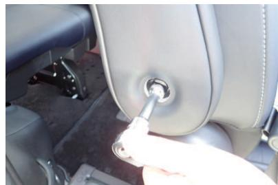
2 ソケットレンチ（14mm）を使用して、ボルトを外し、アームレストをシートから外します。
