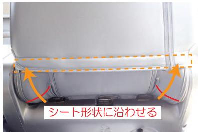
11 引き出した生地の両端を、外側に引っ張りシート形状に沿わせるようにします。引き出した3枚の生地と、カバー背面の生地に付いているマジックテープを固定します。
