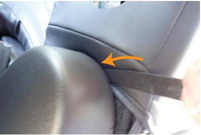
**13** カバー左右の軸部分の生地を、シートとプラスチックカバーの隙間に入れ込みます。
