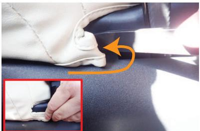
7 カバー内側面のシートベルトバックル付近の生地（赤枠参照）を、ヘラ等を使用し、シートに巻き込むようにしながら、プラスチック部の隙間に入れ込みます。
