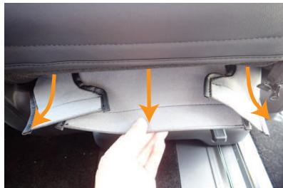
10 入れ込んだ生地を背面から引き出します。引き出した生地の両端は、外側に引き出します。また、両端のL字になっている生地の先端部分は中央の生地の上側に重ねるようにして下さい。
