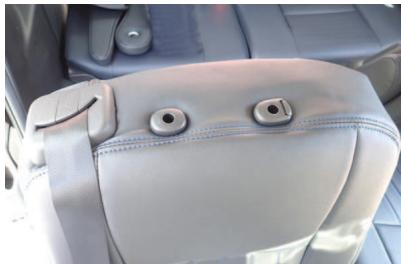
7 カバーの加工穴から生地の伸びを利用してヘッドレストの台座を取り出します。
