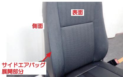
1 SRSサイドエアバッグ展開部分は、シートの表面と側面の境界線に位置し、図の縫い目に配置されます。
