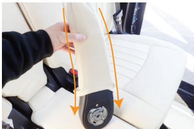
1 カバーの向きを確認します。加工穴が大きい方が、アームレストの内側になります。カバーの加工穴の大きい方にアームレストを通し、かぶせます。アームレスト先端までしっかりととかぶせて下さい。
