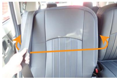
3 カバー背面のファスナーを開き、シートベルトの内側を通して、シート全体にカバーをかぶせます。
