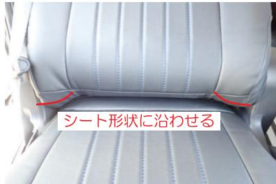
12 マジックテープの固定後に、シートを後ろに倒した状態で、両端に引き出した生地がシート形状に沿っている事を確認して下さい。
