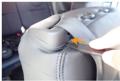
6 シートベルトの台座とシートの隙間に生地を入れ込みます。
