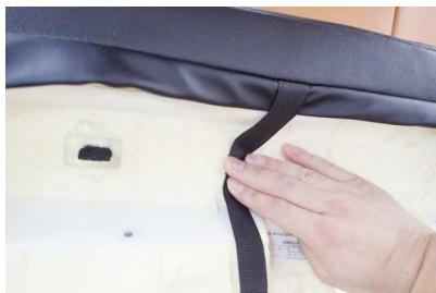
10 シートを裏返し、カバー前後に付いているベルトを固定します。シートを車体に戻す際にベルトが干渉して切れてしまわないよう、シートのくぼみに沿わせて、手で押さえるようにしながら締め付け具合を調整して下さい。
