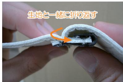
5 プラフックの固定方法は、カギ状のプラスチックパーツに、板状のプラスチックパーツを、生地ごと巻き込むようにめ込み固定します。
