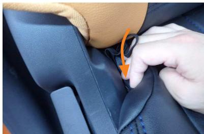
7 カバー両側面のゴムが付いた生地を、シートとプラスチック部の隙間に入れ込みます。
