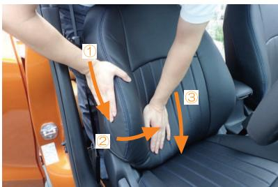
7 図の①～③の順番に側面の生地をシートに馴染ませるようにしながら、カバーのラインを整えます。側面のシワが無くなるまで繰り返し行って下さい。
