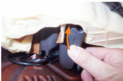
15 取り外したシートベルトバックルをシートから取り出します。
