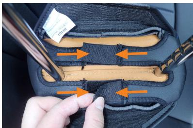
3 ヘッドレストを台座から取り外し、カバー底面の左右に付いているマジックテープを固定します。
