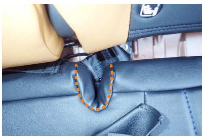
9 シートのくぼみに合わせて、カバーの位置を調整します。
