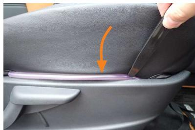
6 シート外側面に付いている固定用部材を、シートとプラスチック部の隙間に入れ込みます。
