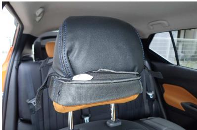
1 1列目ヘッドレストにカバーを半分ほど裏返した状態でかぶせます。板状のプラスチックパーツが付いている方が前側になります。この際ヘッドレストの先端まで生地が張るように、しっかりととかぶせて下さい。
