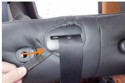
7 シートベルトの台座部の隙間に生地を入れ込みます。
