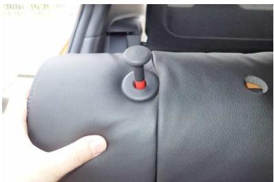
5 ヘッドレストの台座と、リクライニング用レバーをカバーの加工穴から取り出します。
