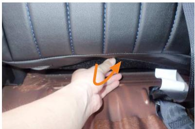
10 背もたれと車体の隙間に生地を入れ込みます。背もたれの角度を調整して入れ込みやすい角度で行って下さい。
