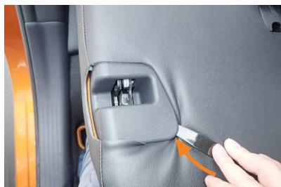
9 カバー外側面のヒンジ部のプラスチックハウジングの隙間に生地を入れ込みます。
