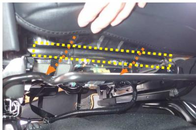
10 カバー前面に付いているベルトを、図の金属部の上側を通して、後ろ側から引き出します。4番で引き出した生地に付いているバックルに、ベルトを通し固定します。
