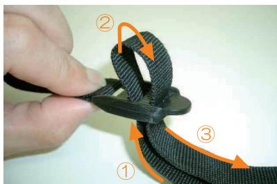
11 ベルトは、図の①～③の順番にバックルに通し、引くことでベルトが締まり固定されます。
