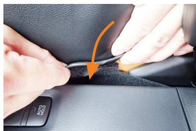
5 シート内側面の生地に付いているマジックテープを、シートに直接貼り付け固定します。
