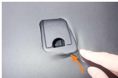
13 カバー背面の「SOFIX用アンカー部」の隙間に生地を入れ込みます。
