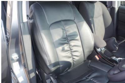
1 カバー両側面のファスナーを開き、シートのラインに合わせカバーをかぶせます。
