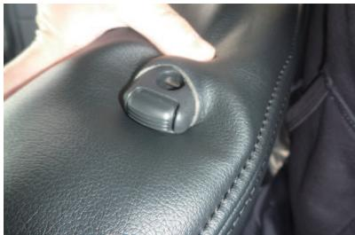
2 カバーの加工穴からヘッドレストの台座を取り出します。まず台座のフチに生地をしっかりと入れ込みます。
