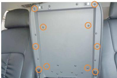
1 コンソールのフタを開き、ドライバーを使用し、図の部分のネジを外します。
