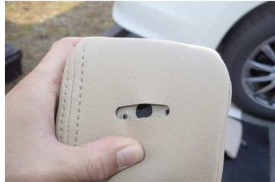
7 シートベルトのガイドのネジ穴とカバーの加工穴の位置が合っていることを確認して元に戻します。
