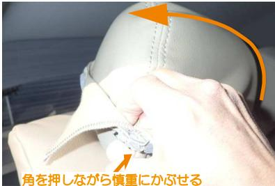
7 ヘッドレスト全体にかぶせていく際、片側の側面の角を指で押しながら慎重にかぶせます。
