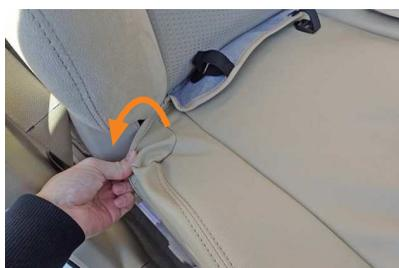
9 シート外側面の付け根に、生地を巻き込むようにかぶせます。
