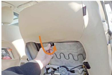
8 シートの背面からカバーを固定します。カバーに付いているプラスチックのフックを、シートの背面にある金属バーに引っ掛けて固定します。
