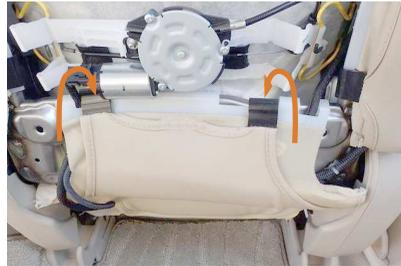
10 4番で引き出した生地が付いているフックを、純正シート地のフックを固定している金属のフレームに引っ掛けて固定します。
