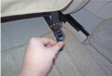
7 8ページ3番で入れ込んだ生地を背面から引き出します。引き出した生地が付いているバックルにベルトを通して、運転席と同様に固定します。
