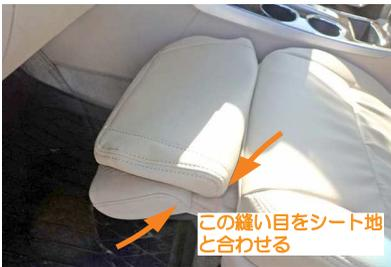
9 オットマンにカバーの装着を行います。カバーの前後を確認します。純正のシート表皮と同様の縫い目が入っている方向にカバーを合わせます。
