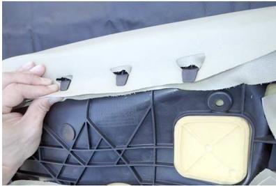
5 カバーを純正シート地が固定されているのと同様に、ツメ部分に生地の切り込み部分を引っ掛けていきます。
