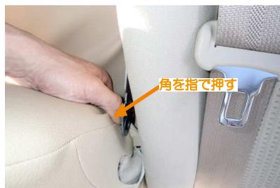
31 車体側の金属フレームをしっかりとかわしながらアームレストを戻していきます。アームレストの角を指で押しながら、慎重に戻します。
