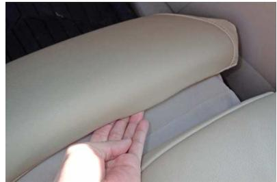
11 オットマン付け根部分の隙間に生地をしっかりと入れ込みます。
