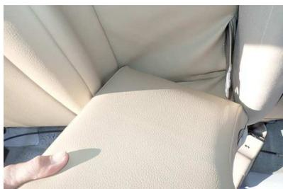
30 アームレストをシートに戻します。軸の穴位置を合わせて入れ込みます。
