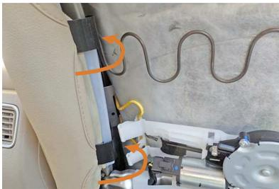
9 シート背面の側面は、純正シート地を固定しているフックの上からカバーの固定フックを引っ掛けて固定します。
