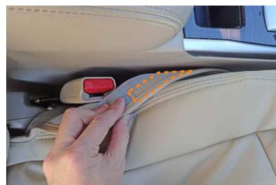
12 カバー内側面に付いているマジックテープを、シートに直接貼り付けて固定します。※マジックテープにはシートの裏地を保護するテープが付いている場合があります。その場合はテープを外してから作業を行って下さい。
