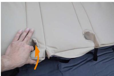
8 シートベルトバックルが出てくる箇の部分に、シートの形状に生地を添わせるように入れ込みます。
