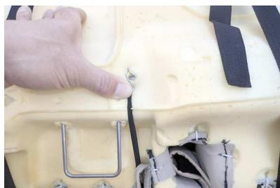
11 金属フックをシート裏の金属フレームに引っ掛けて固定します。
