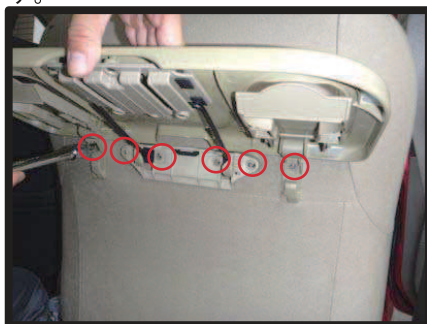
④ラチェットレンチ等で運転席シート バック格納式テーブルを固定してい るナットを外します。
