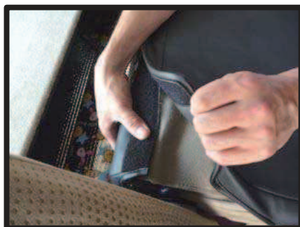
⑫カバーの背面下と引き出した生地を マジックテープで固定します。
