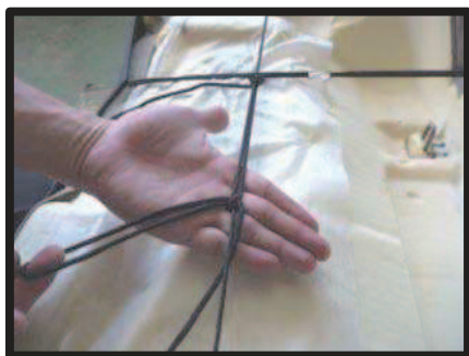
⑨通したヒモを絞り込んでから結び留めます。 ヒモを強く引き絞るとヒモが切れる恐れがありますのでご注意ください。
