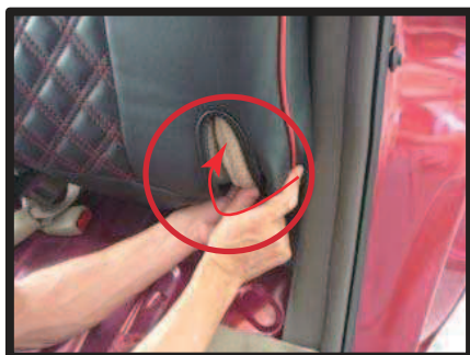
⑨シートを軽く押しながら丸印部分に カバーをかぶせます。
