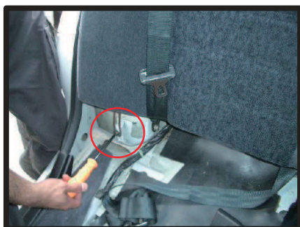
③シートの下部にもネジがありますので、+ドライバーで外します。
