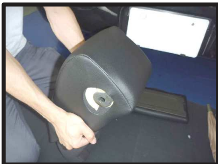
⑩アームレスト本体にカバーをかぶせます。アームレスト後方側から図のようにかぶせます。
