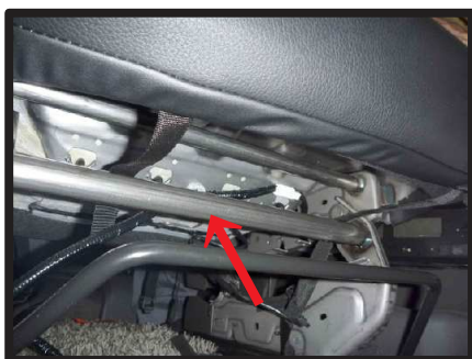
⑫カバー前部のベルトを図の矢印位置の金属バーの上を通し、後ろ側へ引き出します。
