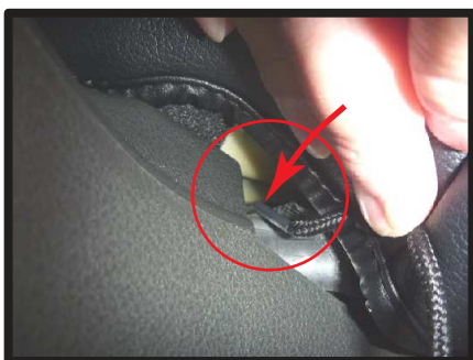
⑨カバー外側面のヒモは、図のように座面付け根の隙間から落とし込み、シート裏側から引き出します。
