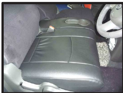
⑰ カバーのラインを整え、1 列目運転席座面の完成です。
