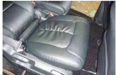
11 カバーのラインを整えて、2列目運転席側座面の完成です。 助手席側も同様に取り付けます。
