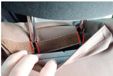
8 ヘッドレストの軸を、カバーのスリット部でかわすようにします。
