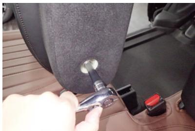
**15** キャップを外すと中にボルトが見えます。ソケットレンチ（13mm）を使用し、ボルトを外すとアームレストが外れます。外したアームレストは、カバー装着後に元に戻します。この際、シート側のアームレスト取り付け部が見えるように、カバーに穴開け加工が必要となります。
