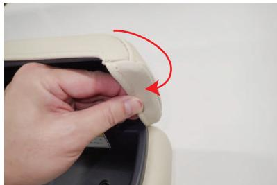
16 コンソールボックスのフタの先端に、カバーを引っ掛けるようにかぶせます。
