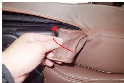
9 シートを倒した状態で、背面の純正表皮をめくり上げ、カバー外側面のマジックテープが付いた生地を、7番と同様に固定します。
