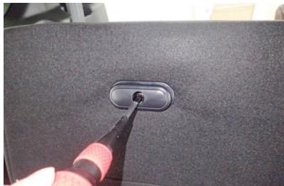
1 シートを跳ね上げて、シート裏に付いているプラスチックパーツを、プラスドライバーを使用し外します。
