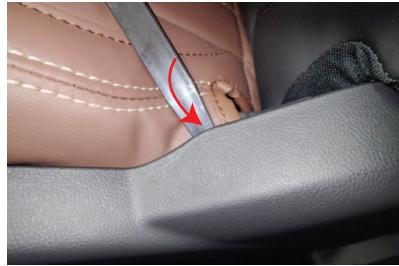
10 図の位置に生地を入れ込む際は、ヘラ等を使用してプラスチックカバーの隙間を広げるようにしながら、矢印方向へ生地を入れ込みます。
