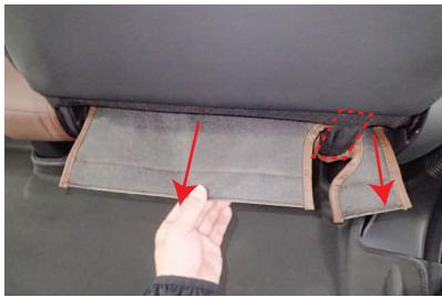
7 入れ込んだ生地を、シートの後ろ側から引き出します。図の配線部分（赤線部）をかわすようにしてください。
