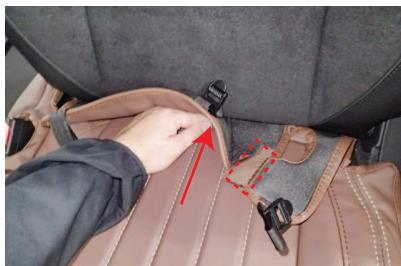
2 マジックテープで固定された生地（赤線部）を外した状態で、背もたれと座面の隙間に生地を入れ込みます。
