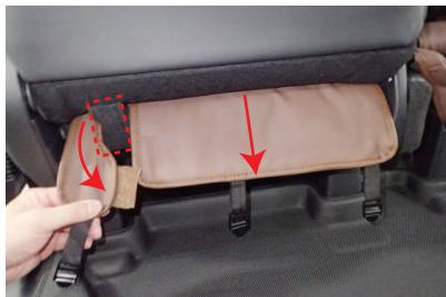
3 入れ込んだ生地を、シートの後ろ側から引き出します。配線部分（赤線部）をかわすようにしてください。
