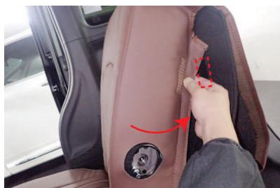
11 アームレスト取り付け位置と、カバーの加工穴位置が合っている事を確認し、内側面の生地も同様に固定します。
