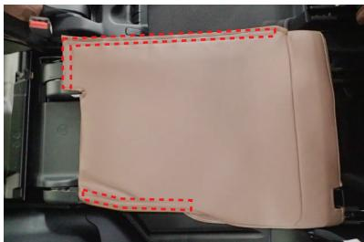
15 カバー背面の生地裏に付いているマジックテープを、シートに直接貼り付け、固定します。
