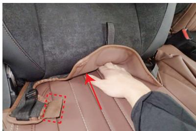
8 マジックテープで固定された生地（赤線部）を外した状態で、背もたれと座面の隙間に生地を入れ込みます。
