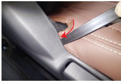
7 図の位置に生地を入れ込む際は、ヘラ等を使用してプラスチックカバーの隙間を広げるようにしながら、矢印方向へ生地を入れ込みます。
