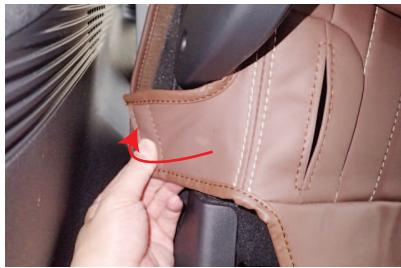
7 5番で引き出した生地の外側面に付いているマジックテープが付いた生地を、シート外側面を覆いながらシート背面に直接貼り付け、固定します。
