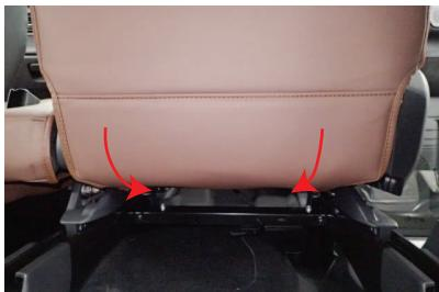
14 金属フックは、シート裏の金属部分に引っ掛け固定します。
