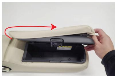
15 カバーの後ろ側をコンソールボックスのフタに引っ掛けるようにし、前側方向にかぶせます。
