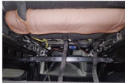
11 運転席と同様に、カバー前後のベルトを固定します。シートを動かした際に、ベルトがシートに干渉していない事を確認してください。
