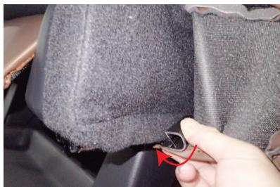
5 カバー内側面に付いているプラスチックフックを、シートのフチに引っ掛け固定します。詳しい固定方法は6番を参照してください。
