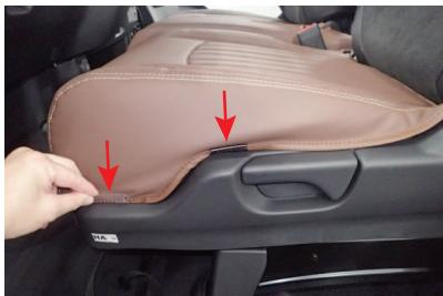
9 カバー外側面の生地を、図の矢印位置にある固定具と一緒にシートとプラスチックカバーの隙間に入れ込みます。
