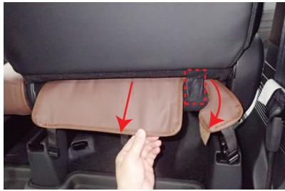
9 入れ込んだ生地を、シートの後ろ側から引き出します。配線部分（赤線部）をかわすようにしてください。
