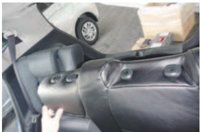
7 1列目と同様に、ヘッドレストの台座をカバーの加工穴から取り出します。
