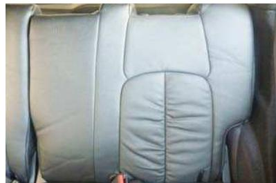
**19** 11ページの4番で外したリクライニングレバーをカバーの生地を挟み込むように元に戻します。
