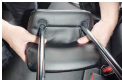
10 ヘッドレストをシートから外し、ヘッドレスト裏で、1列目と同様にプラフックでカバーを固定します。
