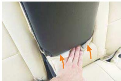
16 中央のアームレスト下側とシートの隙間に生地を入れ込みます。
