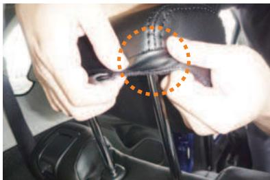
8 カバーを左右均等にかぶせていきます。図の○位置にカバーをかぶせる際は、生地を破らないよう、慎重に作業を行って下さい。
