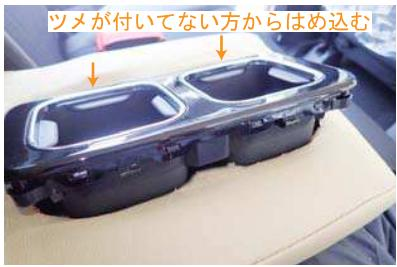
7 ドリンクホルダー装備車は、外した時と逆の手順でカバーを挟み込むようにして元に戻します。
