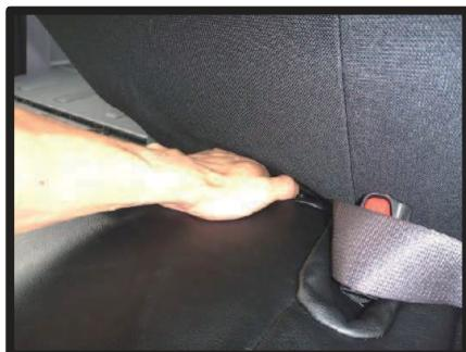
⑥背もたれと座面の隙間に生地を入れ込みます。生地はシート奥まで入れ込み、シート本体に直接マジックテープで固定します。
