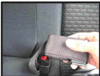
②背もたれのポケットに収納されているシートベルトも取り出し、シートベルトの付け根付近でゴムで固定されている場合は、ゴムから外します。
