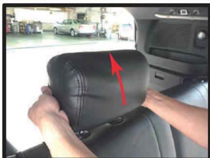
⑥ 2列目ヘッドレストの取り付けは、図のようにヘッドレスト前端にカバーを引っ掛けるようにかぶせます。
