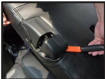
⑩シート側面のプラスチック部に生地を入れ込みます。プラスチック部の裏側は、ヘラ等を使用しシートの隙間に生地を入れ込みます。
