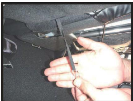
⑪⑤で入れ込んだ生地についているゴムをシート裏から取り出します。S字フックを取り付けシート裏の金属部分に引っ掛け固定します。
