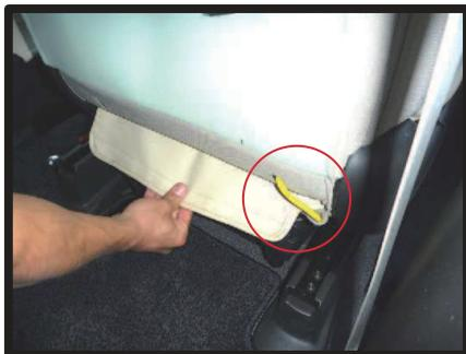
⑥⑤の作業でサイドエアバッグ装備車はシートの裏側に配線がありますので配線をかまし、生地を引き出して下さい。
