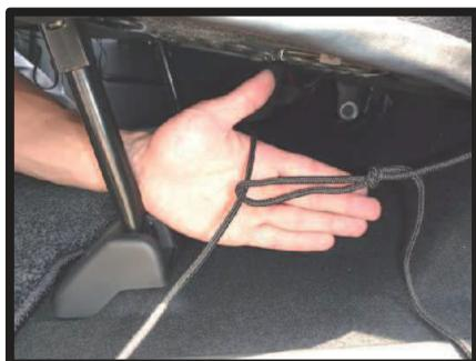
⑨ヒモは図のように片方のヒモで輪を作り、もう片方のヒモをその輪に通します。通したヒモを引くことでシートの下回りを絞り込み固定します。— 6 —
