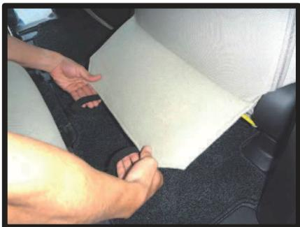
①サイドエアバッグ装備車は背もたれ下から座面裏に回っている図の部分を外して、カバーの取り付けを行います。図の部分は座面裏にフック2ヶ所で留まっています。
