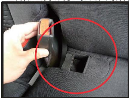
①〇印のポケットに収納されているシートベルトバックルを、ゴムを外しポケットから取り出しておきます。
