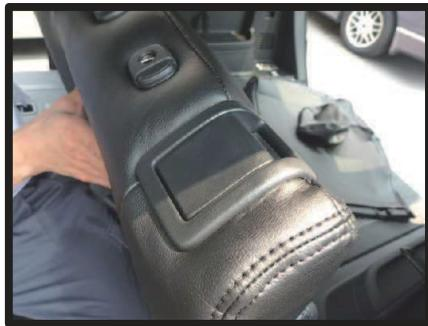
⑨リクライニングレバーを浮かせた状態で生地を入れ込みます。入れ込んだ生地を挟み込むようにリクライニングレバーをネジで固定し直します。
