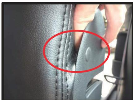
⑪プラスチック部の側面側です。生地に丸く穴開け加工している部分は、プラスチック部を図のようにめくるとクリップの先が見えますので、その先に穴を通して下さい。
