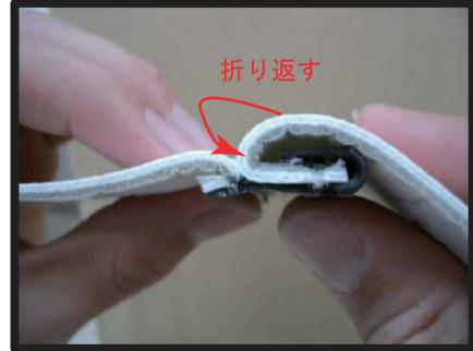
③プラフックの固定方法は、図のように平らな形状の方を、生地ごと巻き込みながら、カギ状の方に引っ掛けるように固定します。
