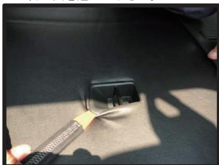
⑫背もたれ背面のチャイルドシート固定バーのプラスチック部を外します。
