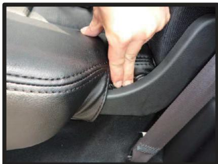
⑬シート付け根部分の生地をプラスチック部の隙間に入れ込みます。
