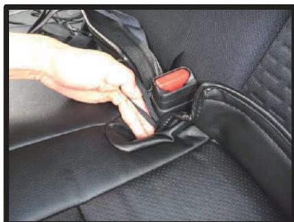
⑤シート中央のシートベルトバックルが出ている隙間に、端にゴムの付いた生地を入れ込みます。
