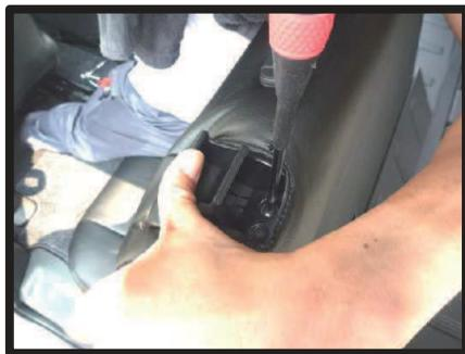
⑦リクライニングレバー部のネジをドライバーを使用し外します。
