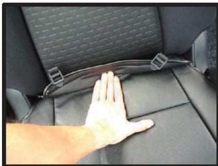
④背もたれと座面の隙間に生地を入れ込みます。背もたれの角度を調整して入れ込みやすい位置で行ってください。
