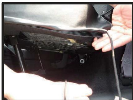
⑧シート外側側面下からカバーの両端から出ているヒモを取り出します。
