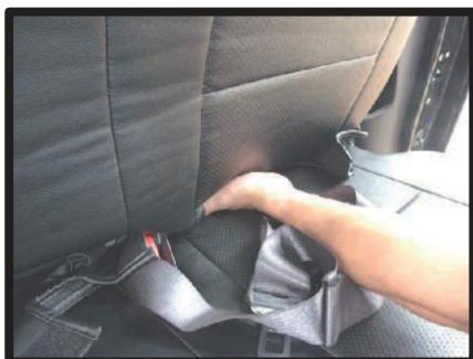
③背もたれを少し前方にリクライニングさせ、背もたれと座面の隙間に生地を入れ込みます。
