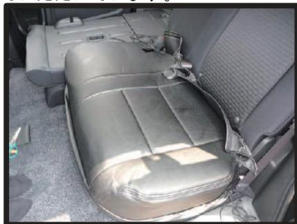
④シートのラインからずれないようにカバーをかぶせます。
