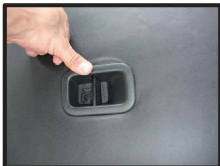
⑭プラスチック部のフチに生地の加工している穴部分を合わせ、生地を挟み込むようにプラスチック部を元に戻します。
