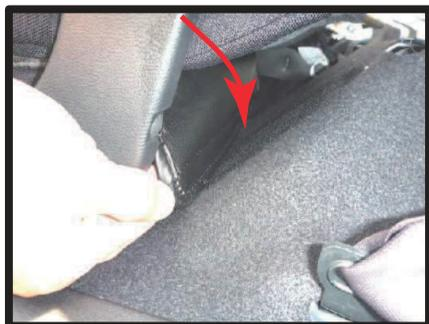
⑦⑥の作業を外側側面から見た図です。生地を矢印方向に入れ込みシート本体に直接マジックテープで固定します。
