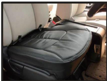
③シート前側のラインにカバー前側のステッチ部分が合うように表面を整えます。
