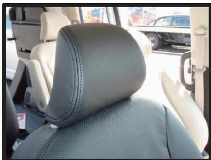
⑤ ヘッドレストを元に戻し、カバーの表面を整え、1列目ヘッドレストの完成です。2列目も同様に取り付けます。
