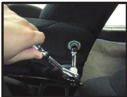
②ラatchetレンチなどを使用し、アームレストを固定しているボルトを外します。
