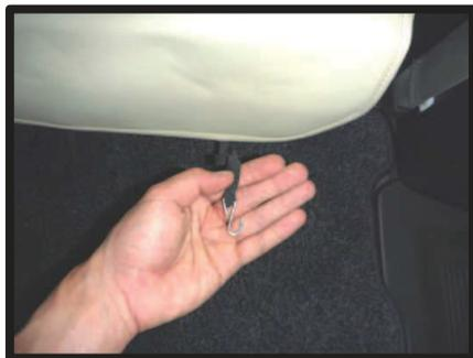
⑩ サイドエアバッグ装備車は背もたれカバー下に1ページの①で外した部分と同様のパーツが付いています。カバー下に付いているゴムに付属のS字フックを取り付け、座面裏の金具部分に引っ掛け固定します。
