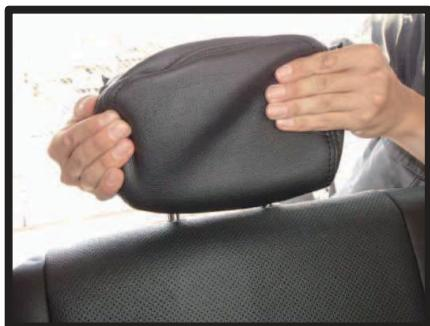
⑥ 3列目ヘッドレストの取り付けは、図のようにヘッドレスト前端にカバーを引っ掛けるようにかぶせます。
