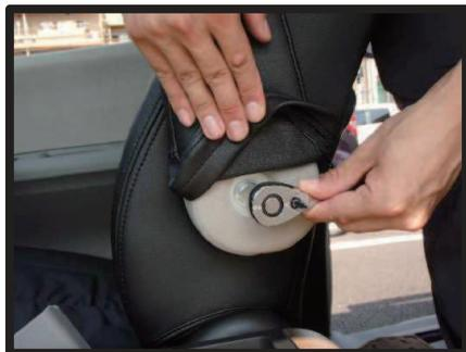
②アームレスト内側のみ、最後までカバーをかぶせた状態で、図のようにアームレストを取り外した逆の手順で、背もたれに取り付けます。
