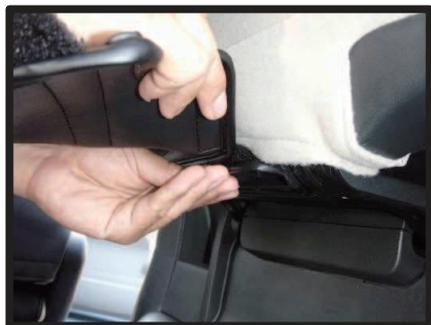
⑩引き出した生地と座面裏側へ回る生地をマジックテープで固定します。
