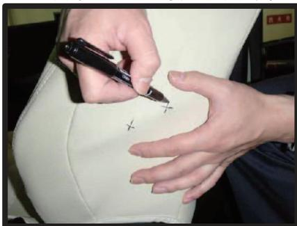
④次に、カバーをかぶせた状態でアームレスト取り付け部の突起のある箇所に印をつけます。(3ヶ所)
