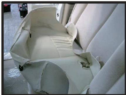
①座面カバーをシートのラインに合わせてかぶせます。
