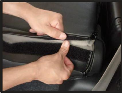
⑤③で引き出した生地を、図のようにマジックテープで固定します。
