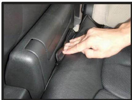
③座面跳ね上げヒンジ部の間に生地を入れ込みます。
