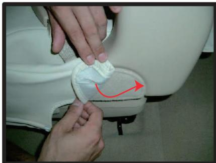
⑤座面内側の側面はシートカバーに付いているゴムを図の位置に引っ掛けて固定します。
