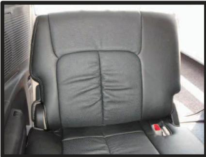
⑥1列目と同様にヘッドレストの台座を取り出し、カバーの表面を整え、3列目背もたれの完成です。助手席側も同様に取り付けます。
