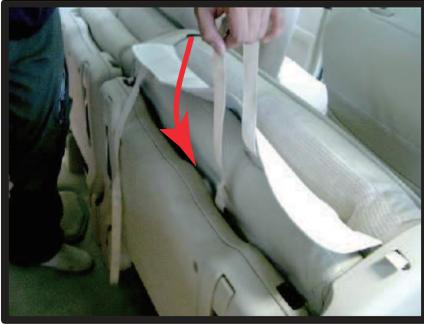
⑧②で入れ込んだ生地を引き出します。シートの土台と本体の間にベルトを通します。
