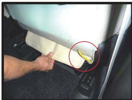
⑥⑤の作業でサイドエアバッグ装備車はシートの裏側に配線がありますので配線をかまし、生地を引き出して下さい。
