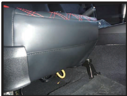
⑯S字フックをシート下の金属部分に引っ掛けると、このようになります。
