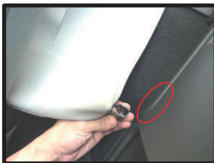
②シートの底面を見ると、図のようにシート本体の生地がプラフックで固定されている場所があります。
